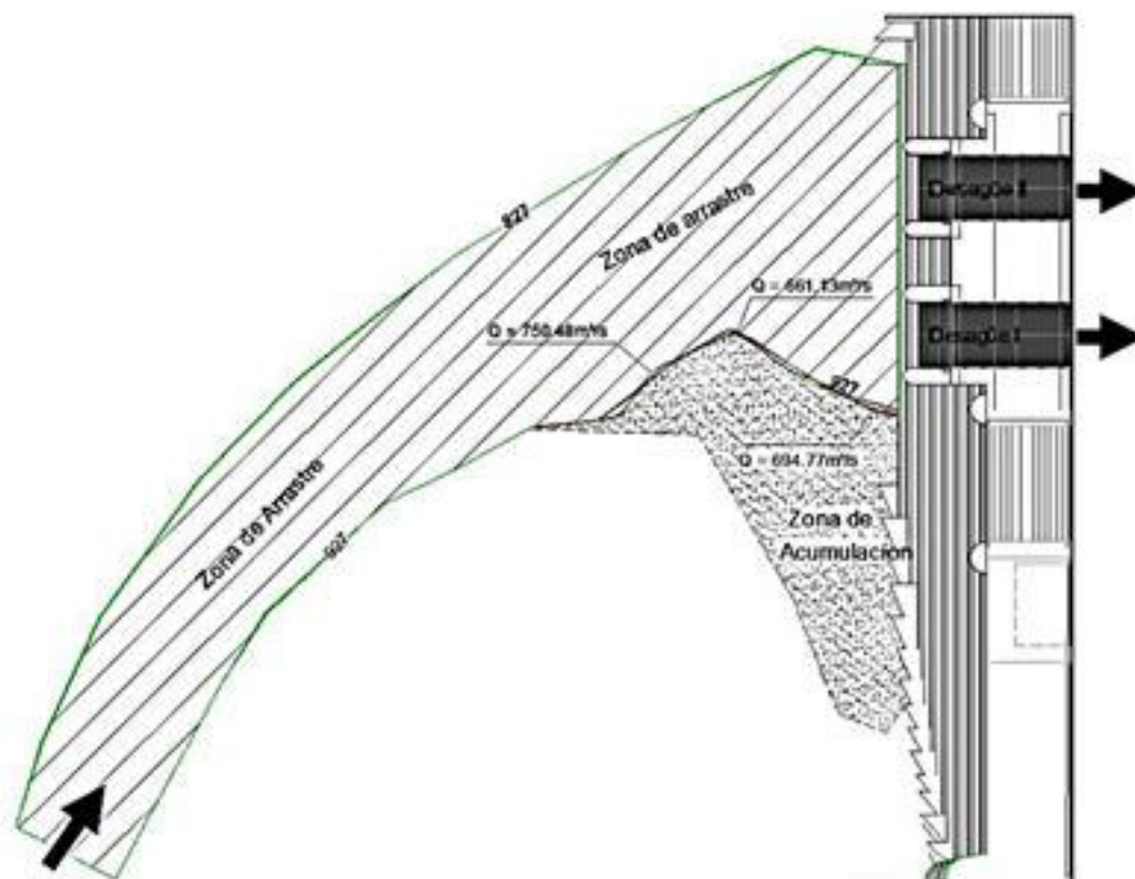
Figura 3.2: Conformación en planta del área de arrastre del material suelto provocado en la prueba I3.
