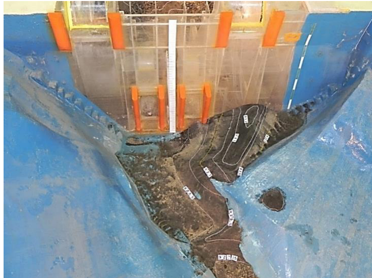
Figura 3.3: Vista de la zona de limpieza producida por la operación de los dos desagües de fondo con un caudal de 750.48 m 3 /s.
