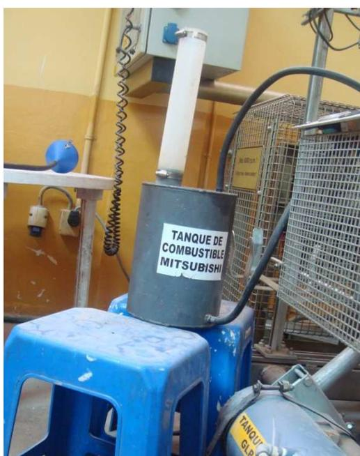
Fig. 3.59 Tanque de de combustible del motor Mitsubishi.
