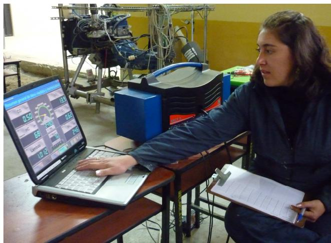
Fig. 2.9 Análisis de gases de escape
