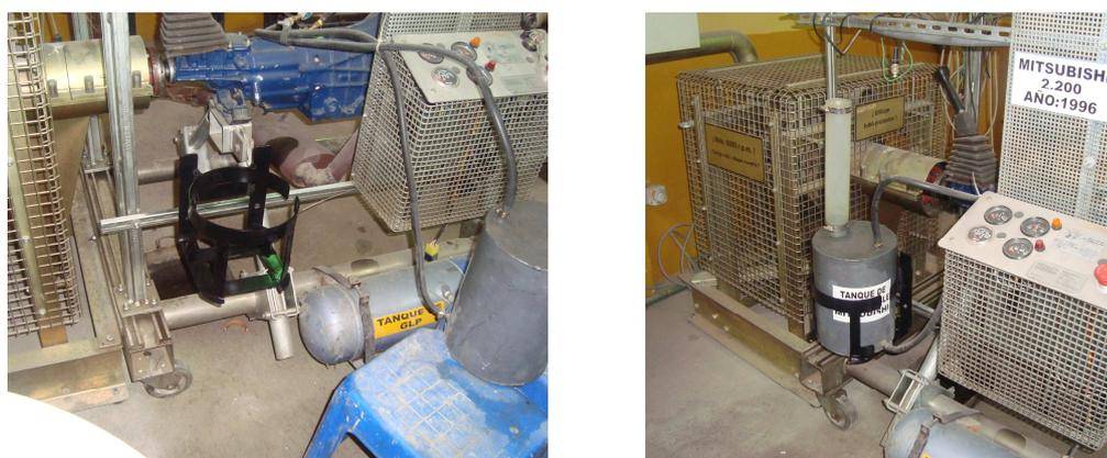
Fig. 3.61 Soporte del tanque de combustible Lada.
