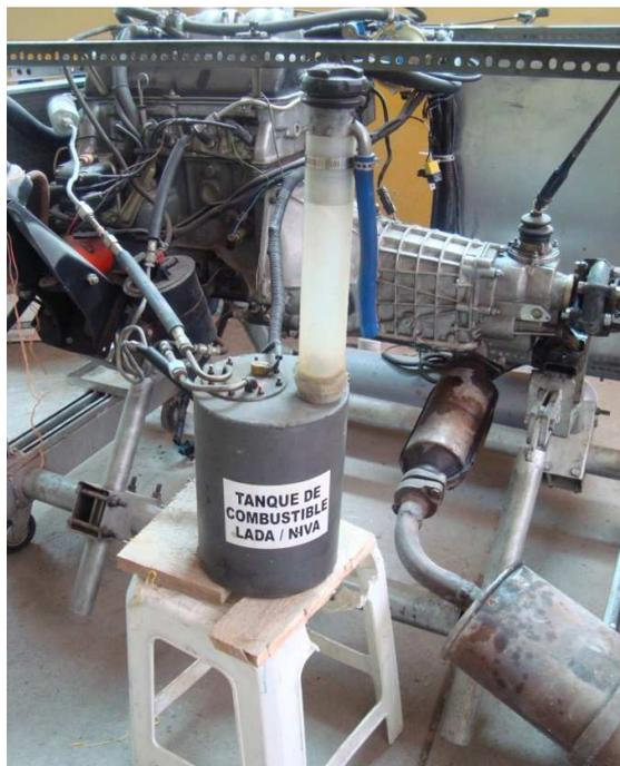
Fig. 3.58 Tanque de combustible del motor lada.
