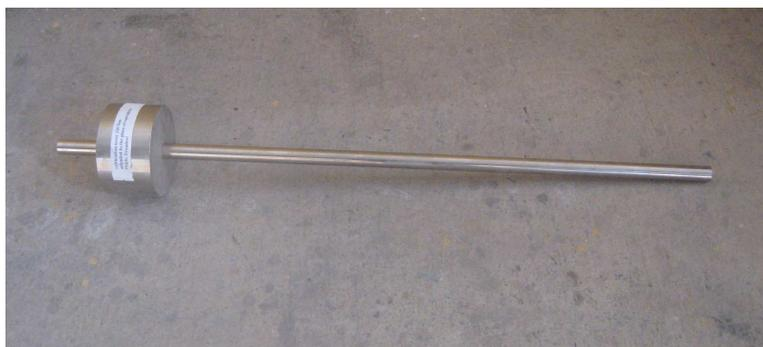
Fig. 2.5 Palanca de calibración 250 Nm.
