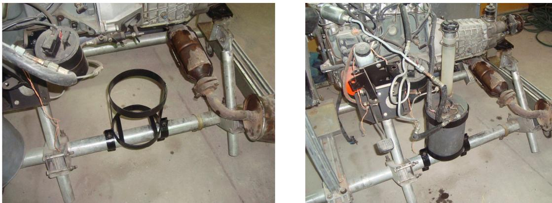
Fig. 3.60 Soporte del tanque de combustible Mitsubishi.
