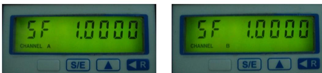
Fig. 3.27 Display mostrando Factor de escala en CH A y B.
