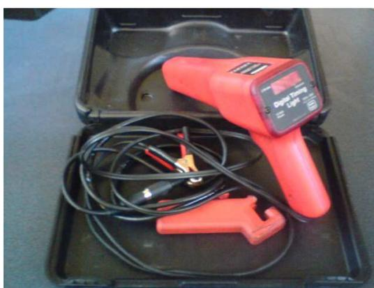
Fig. 2.7 Lámpara Estroboscópica
