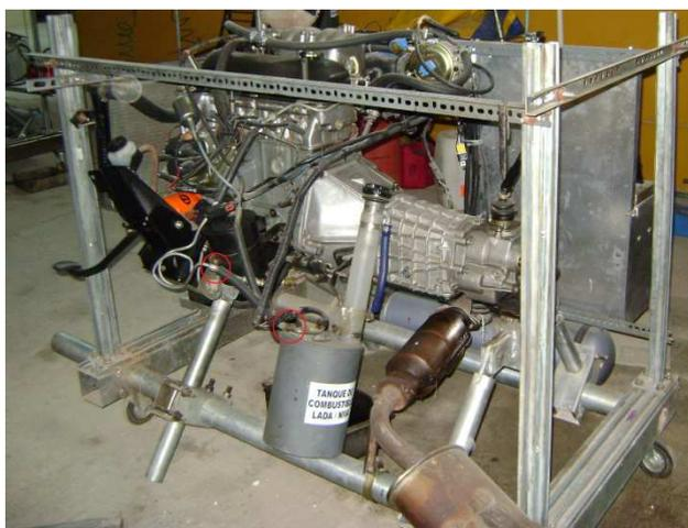
Fig. 3.45 Ubicación de flujómetros en el motor de inyección.
