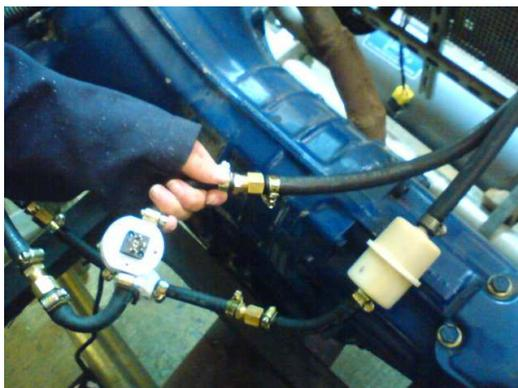
Fig. 3.44 Instalación de los flujómetros.
