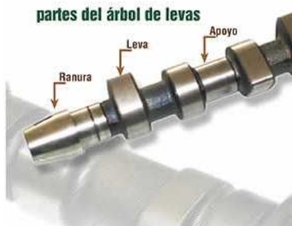
Fig. 1.7 Componentes de un árbol de levas típico.
