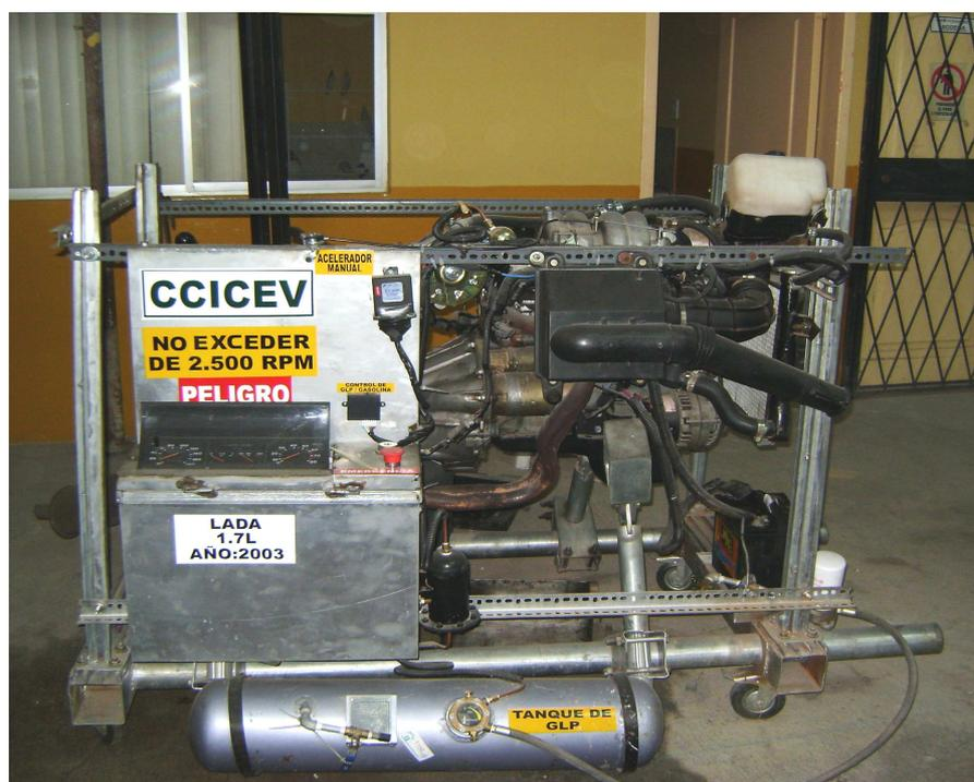
Fig. 2.2 Motor con inyección electrónica
