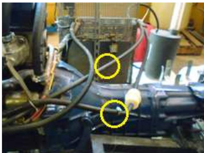
Fig. 3.40 Ubicación de los flujómetros.
