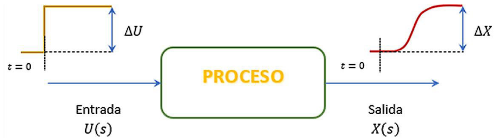
Figura 1.2. Obtención de la curva de reacción de proceso
