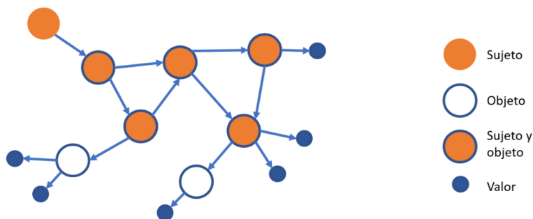
Figura 4. Grafo de datos enlazados del modelo de datos de JSON-LD.
