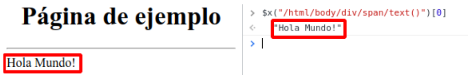
Figura 9. Extracción del texto Hola Mundo! del documento HTML mediante XPath en la consola de Google Chrome.
