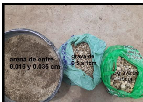
Figura 38. Distintos tamaños de grava utilizada.
