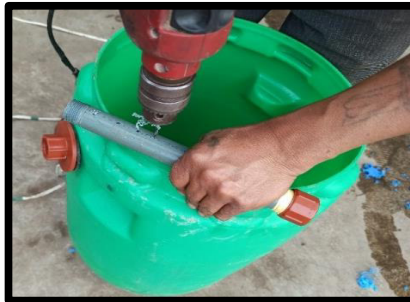
Figura 36. Perforación al tubo para que ingrese el agua al filtro.
