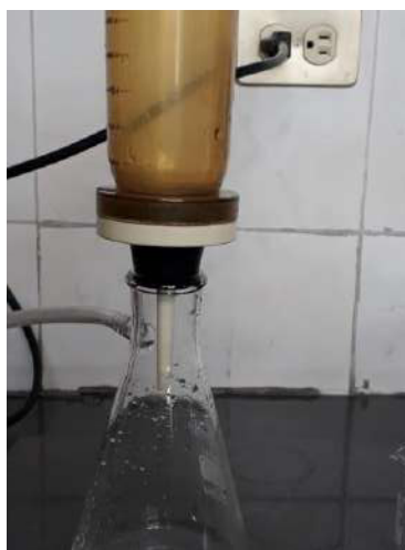
Figura 17. Filtración de muestra de agua
