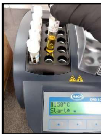
Figura 18. Colación de muestras en el reactor para DQO
