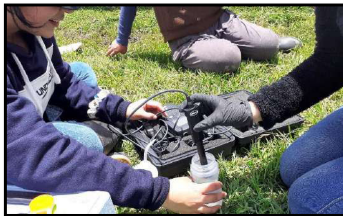
Figura 15. Medición de pH in situ
