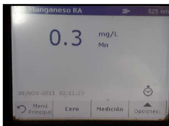
Figura 22. Medición de Mn en el espectrofotómetro
