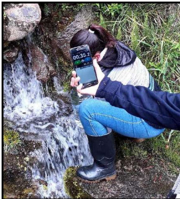
Figura 25. Medición de caudal en la fuente
