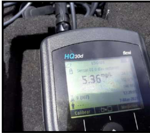
Figura 14. Medición de O.D. in situ
