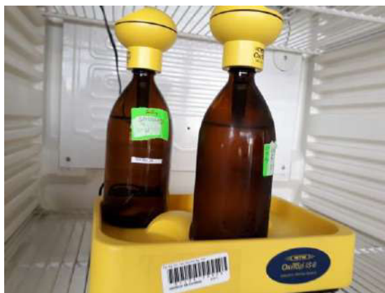
Figura 19. Colocación de Oxitop en la incubadora
