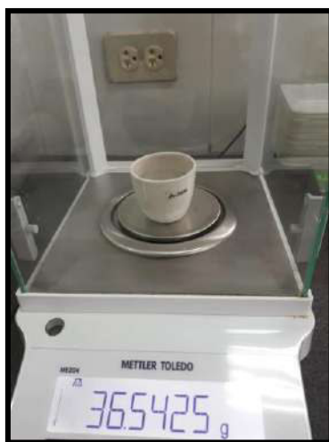
Figura 16. Peso de crisol en balanza analítica
