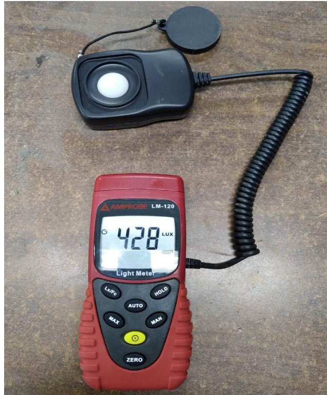
Figura 3.40 Prueba de iluminancia en el punto B.
