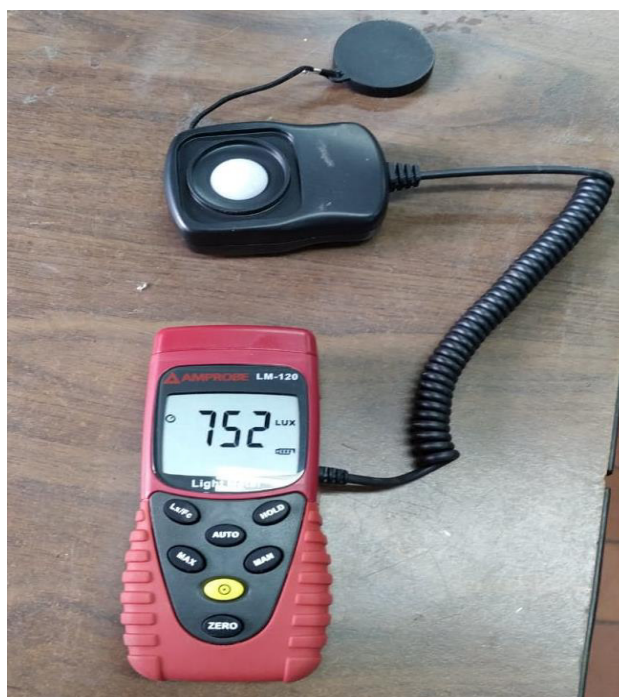
Figura 3.39 Prueba de iluminancia en el punto A.
