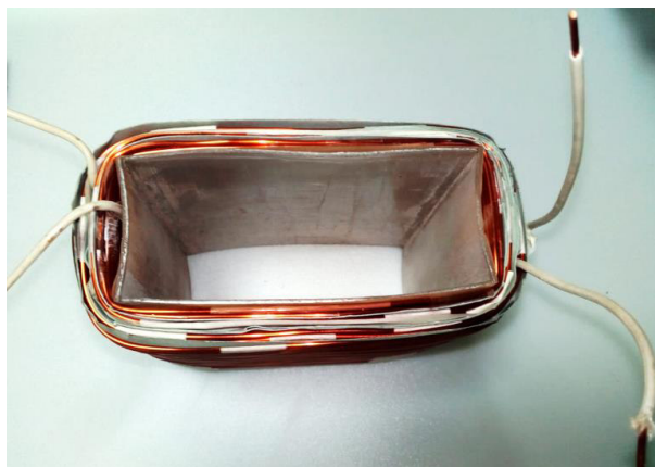
Figura 3.24 Devanado completo de una columna correctamente aislada.
