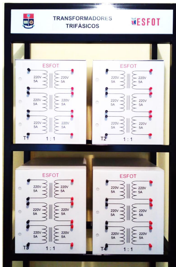
Figura 3.29 Estante de transformadores trifásicos.
