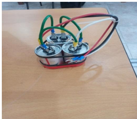
Figura 3.27 Bancos de capacitores trifásicos armados.
