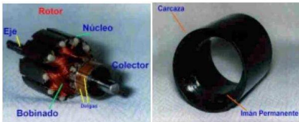
Figura 1.3 Partes fundamentales de un motor de corriente continua
