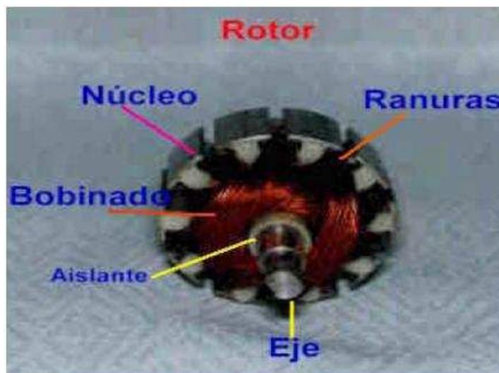
Figura 1.4 Detalle del rotor
