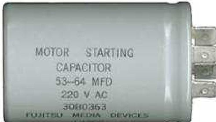
Figura 2.3 Capacitor de arranque del motor
