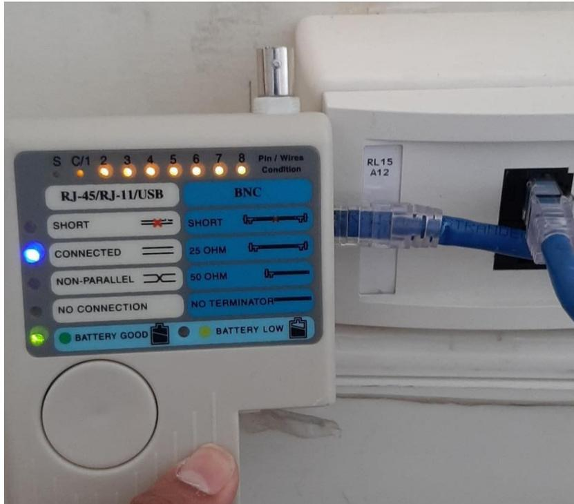
Figura D3 Prueba de funcionamiento punto de red RL15.A12
