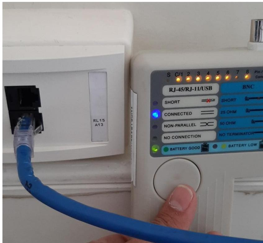
Figura D4 Prueba de funcionamiento punto de red RL15.A13
