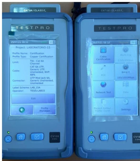
**Figura 3.48** Certificador TEST-PRO CV100-K50
