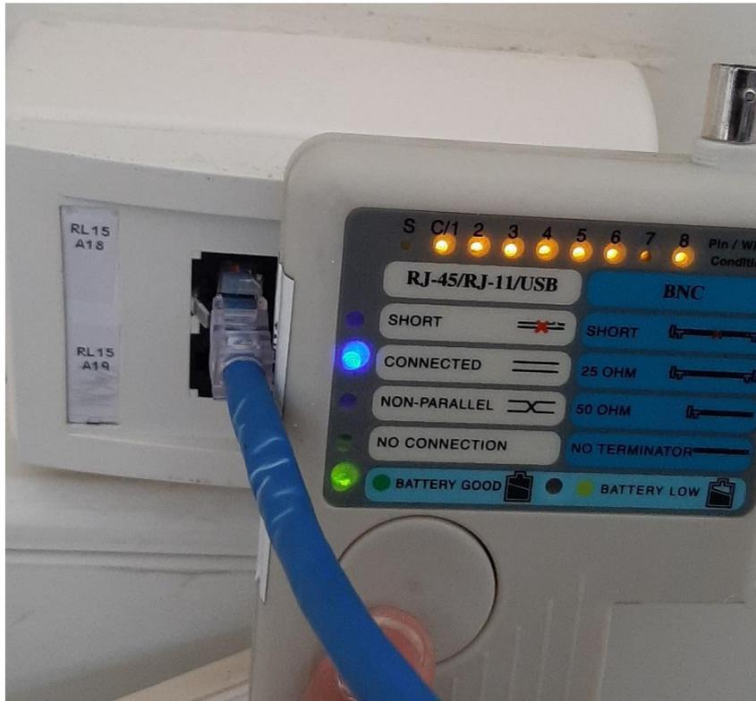
**Figura D9** Prueba de funcionamiento punto de red RL15.A18
