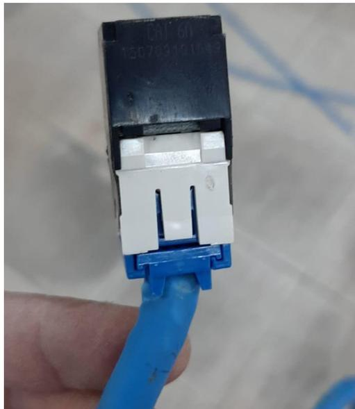
**Figura 3.28** Estado final del ponchado de los *jacks* RJ45 hembra
