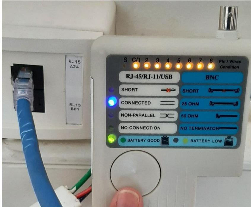
**Figura D15** Prueba de funcionamiento punto de red RL15.A24
