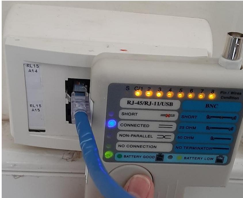
**Figura D5** Prueba de funcionamiento punto de red RL15.A14
