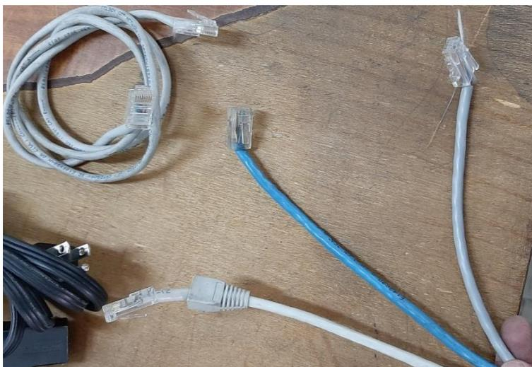
**Figura 3.4** Patch cords utilizados en las estaciones de trabajo
