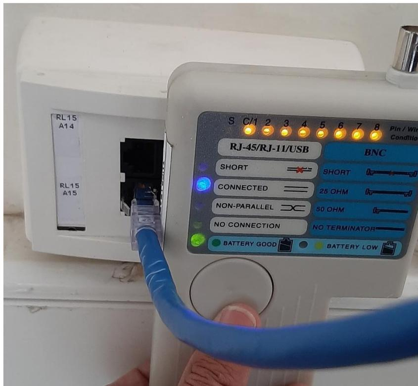
**Figura D6** Prueba de funcionamiento punto de red RL15.A15
