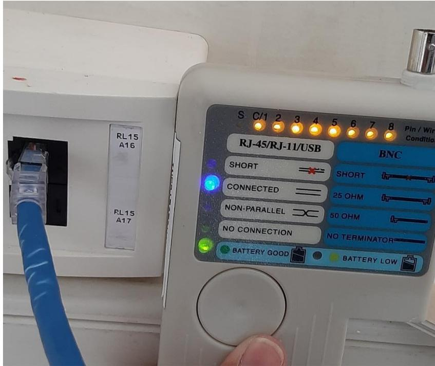
Figura D7 Prueba de funcionamiento punto de red RL15.A16
