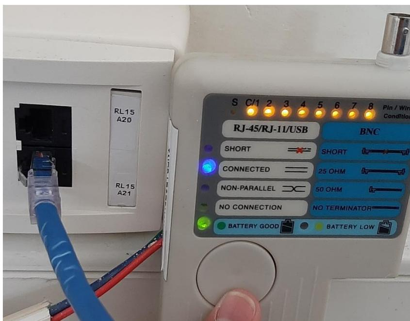
Figura D12 Prueba de funcionamiento punto de red RL15.A21
