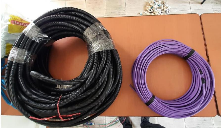
**Figura 3.44** Cable UTP CAT6A Siemon y manguera corrugada adquiridos
