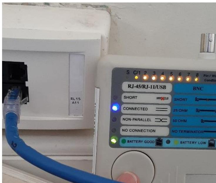
**Figura 3.47** Pruebas de funcionamiento para el punto de red RL15.A11
