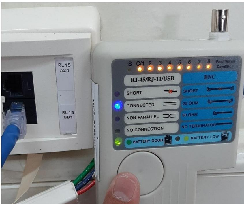
**Figura D16** Prueba de funcionamiento punto de red RL15.B01
