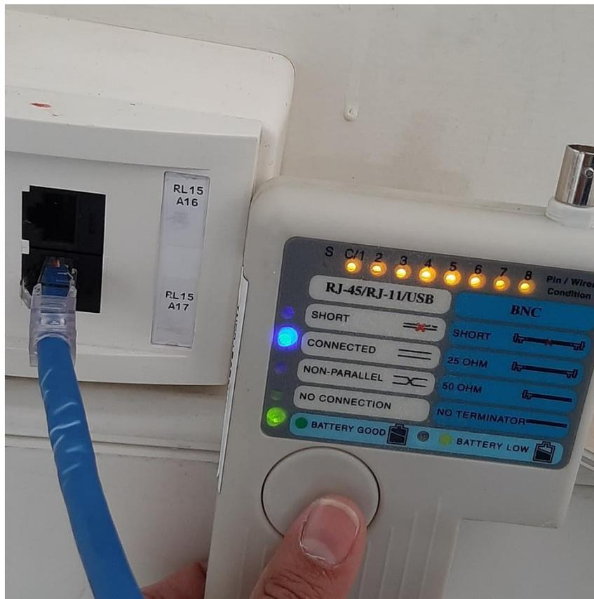
Figura D8 Prueba de funcionamiento punto de red RL15.A17
