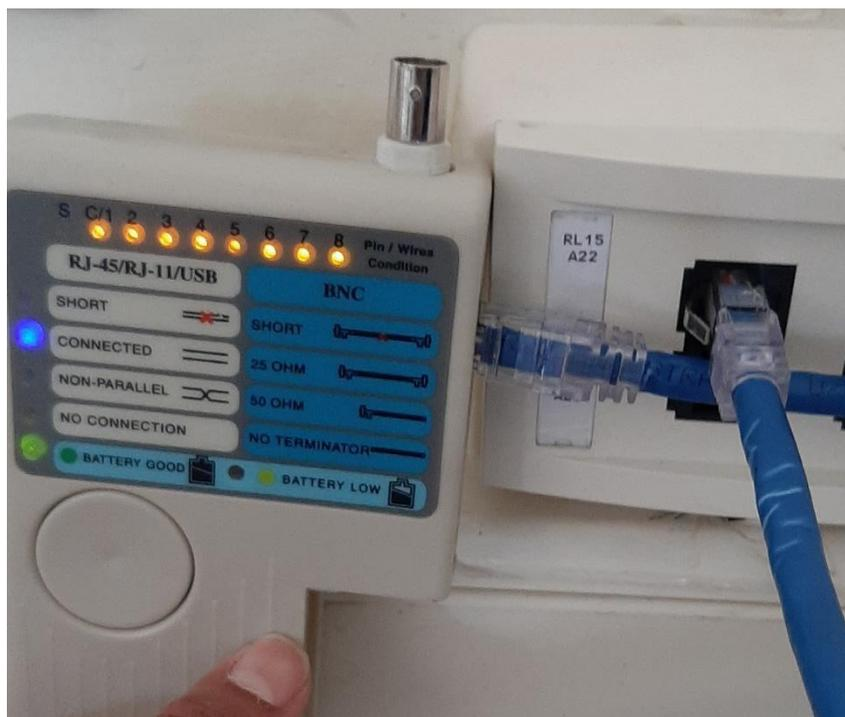
**Figura D13** Prueba de funcionamiento punto de red RL15.A22
