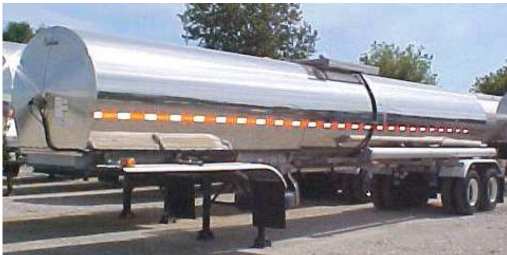
Figura 2.12. Semiremolque cisterna de dos ejes con tanque de forma elíptica con capacidad de 8.000 galones
