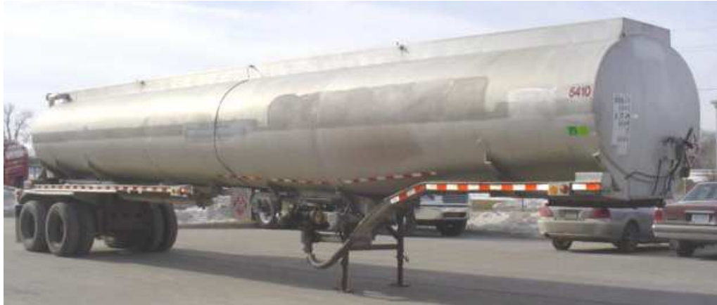
Figura 2.11. Semiremolque cisterna de dos ejes con tanque de forma elíptica con capacidad de 10.000 galones
