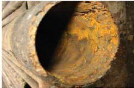
**Figura 1.5** Erosión corrosión por CO<sub>2</sub> en una TP
