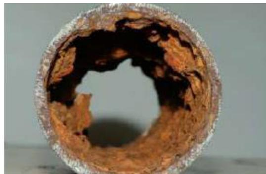
**Figura 1.4** MIC en la superficie interna de una tubería
