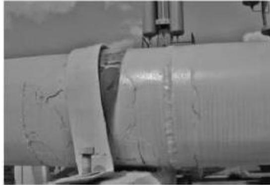
**Figura 1.3** Corrosión por grietas debajo de la correa de restricción de una tubería
