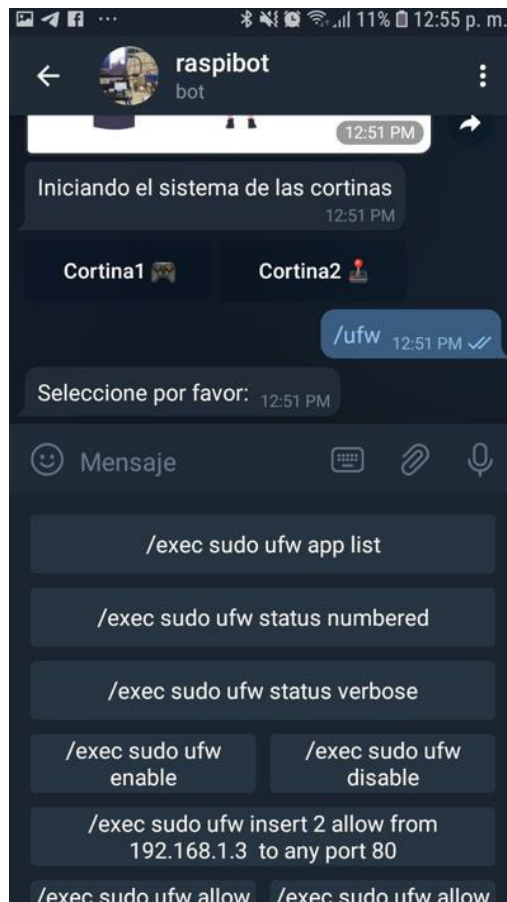
Figura 3.410 Menú de la configuración del cortafuegos
