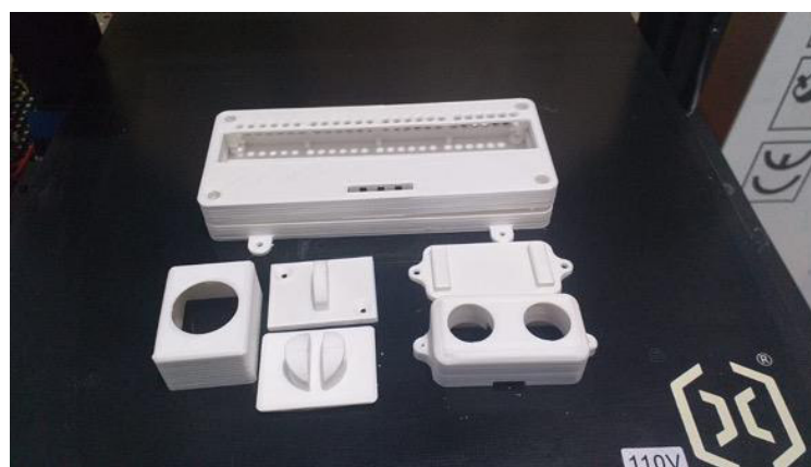
Figura 3.291 Piezas para los sensores y el módulo relé
