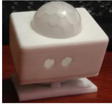
Figura 3.296 Armado de las piezas que contendrán al sensor PIR
