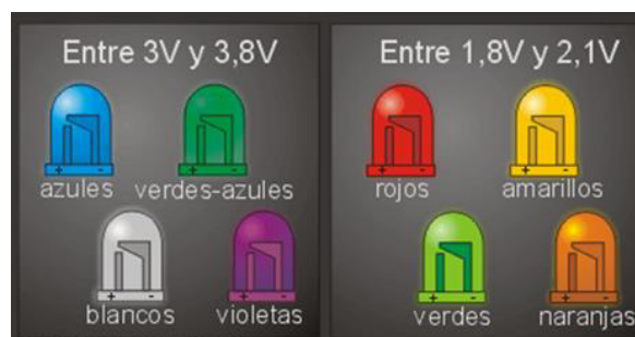
Figura 3.57 Leds según su consumo de tensión [13]
