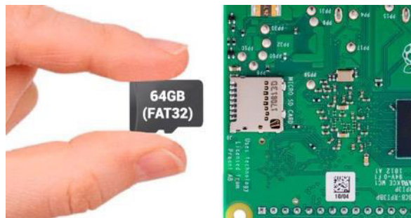
Figura 3.4 Colocación de la tarjeta microSD [31]
