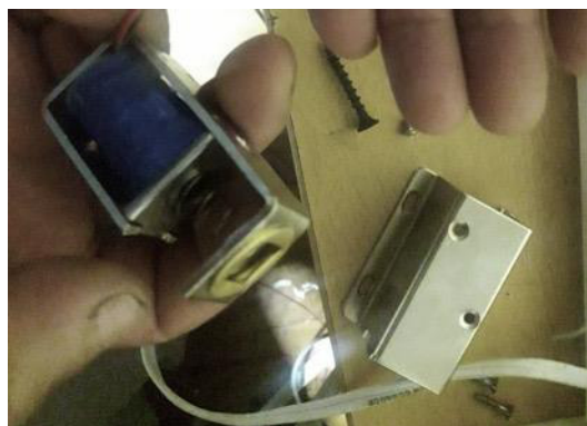
Figura 3.309 Cambio de la posición del eje del cerrojo
