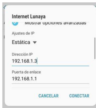
Figura 3.396 Configuración de dirección IP estática en el celular
