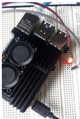
Figura 3.59 Implementación del encendido y apagado de un led desde la terminal
