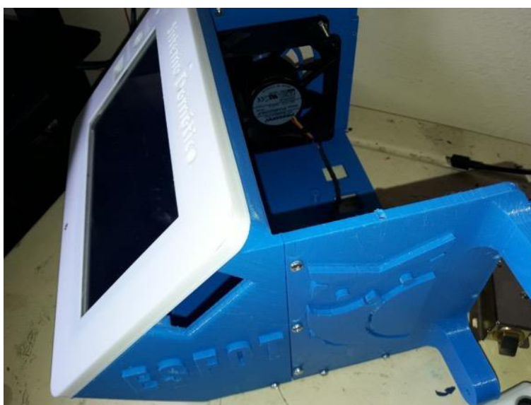
Figura 3.298 Colocación de la pantalla 7inch HDMI LCD (C) y el ventilador
