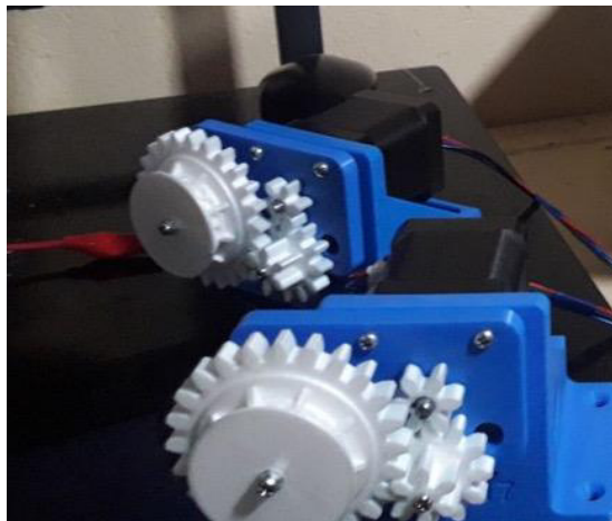
Figura 3.297 Armado de las piezas del sistema de las cortinas
