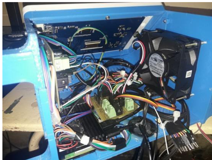
Figura 3.300 Colocación de la Raspberry Pi y la segunda placa
