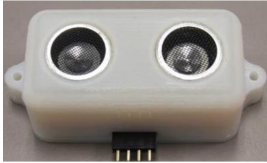
Figura 3.294 Armado de las piezas que contendrán al sensor ultrasónico
