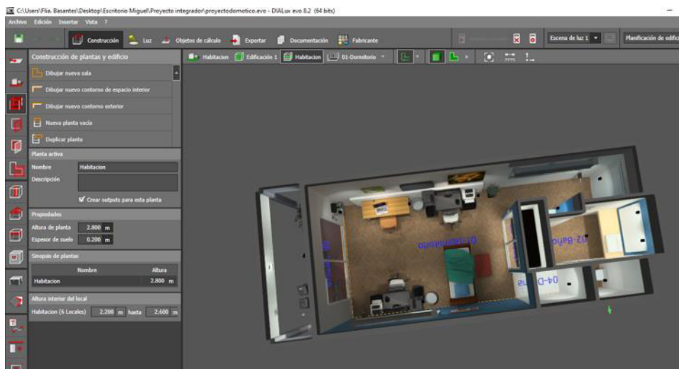
Figura 3.173 Diseño 3D de un domicilio por medio de un plano
