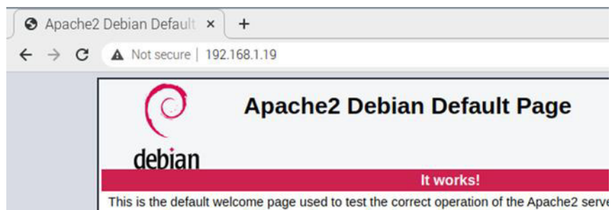
Figura 3.202 Comprobación del funcionamiento de Apache en el navegador
