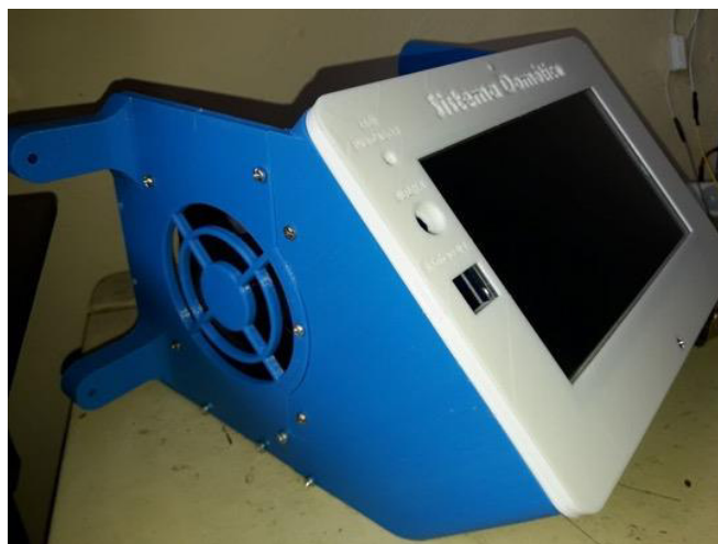
Figura 3.293 Armado de la estructura del prototipo
