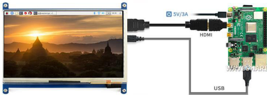
Figura 3.166 Esquema de conexión de la pantalla 7inch HDMI LCD(C)
