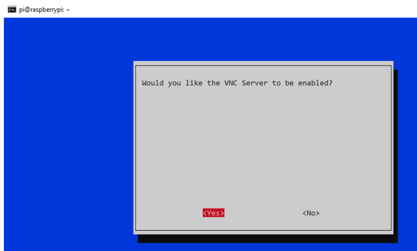
Figura 3.22 Habilitación del servidor VNC
