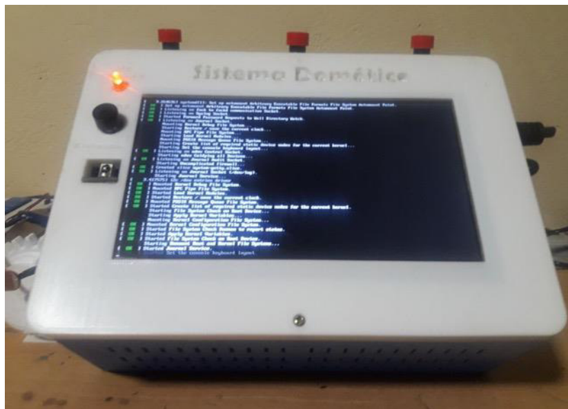
Figura 3.341 Led indicador del encendido del prototipo
