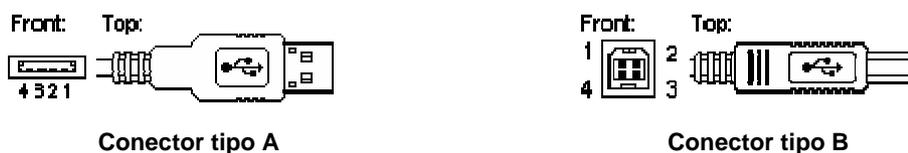
Figura 2.27 Tipos de conectores USB.
