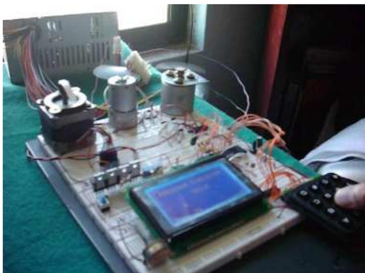
Figura 3.13 Motores DC en marcha.
