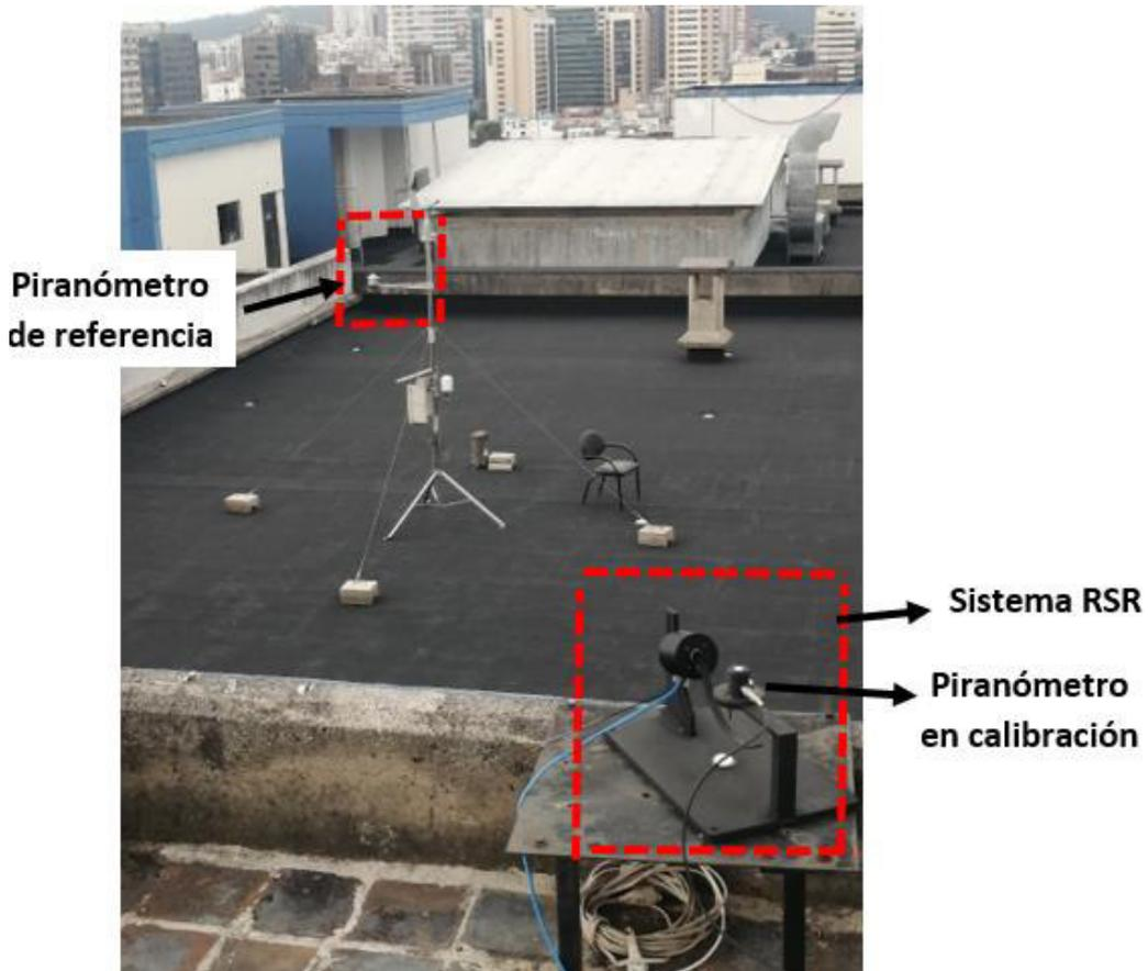
**Figura 3.7** Ubicación del piranómetro de referencia y del piranómetro en calibración, ubicados a una distancia de 15 metros.
