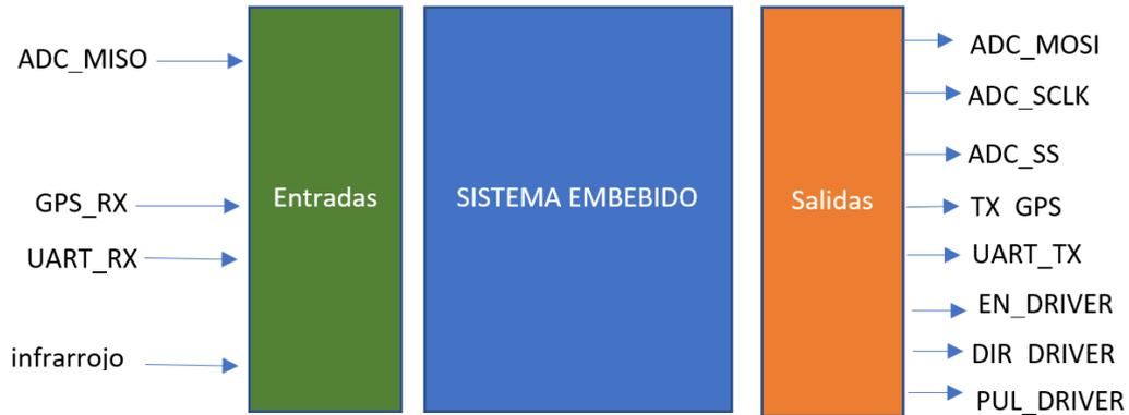
**Figura 2.23** Diagrama de E/S del Sistema Embebido 1.
