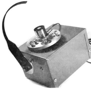
**Figura 1.11** Diseño RSR original de Wesley para medir irradiaciones difusas y globales para poder estimar la irradiancia normal directa.
