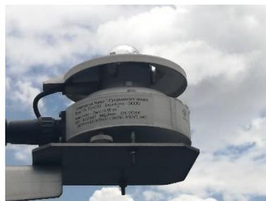
**Figura 2.60** Piranómetro Nippon Electric Instrument
