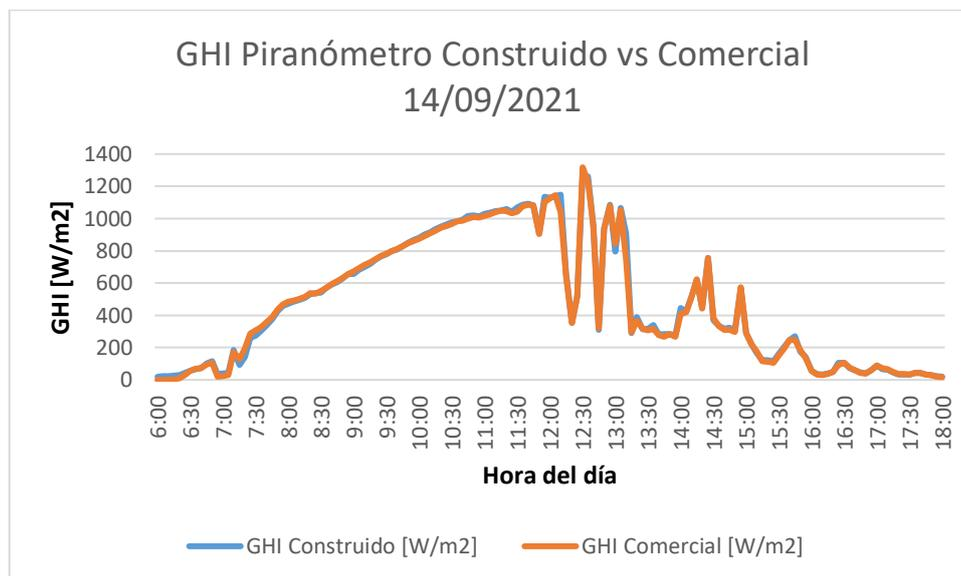
**Figura 3.11** Mediciones de GHI del piranómetro construido y el piranómetro comercial el 14 de septiembre de 2021.
