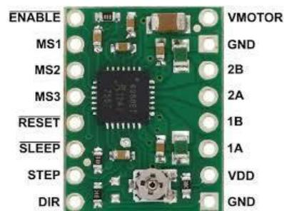
**Figura 2.41** Driver A4988 para controlar motor a pasos [32]
