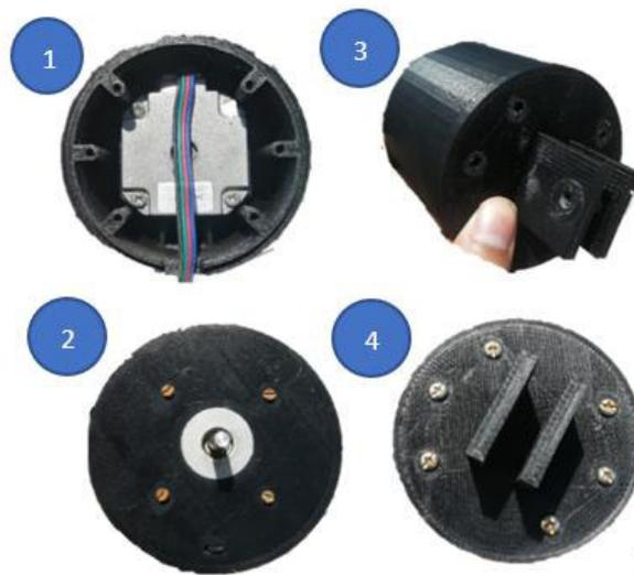
**Figura I.3.** Procedimiento del montaje del motor y el sensor magnético a la carcasa del motor
