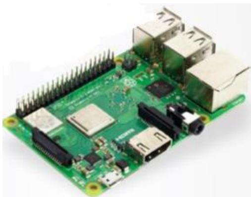
**Figura 2.46** Tarjeta Embebida Raspberry Pi 3 B+
