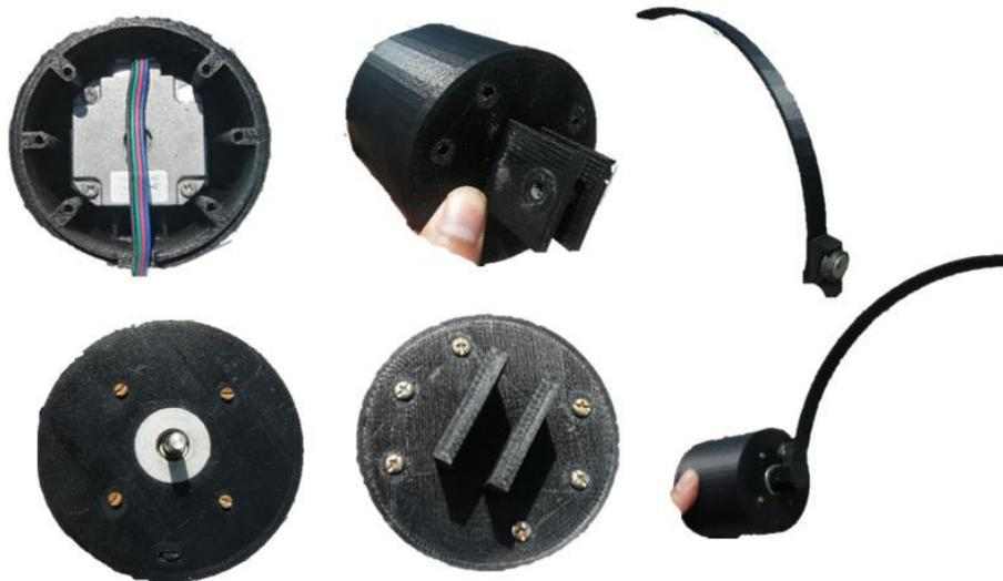
**Figura 3.4** Vista de la carcasa del motor y la sombra de banda del sistema RSR
