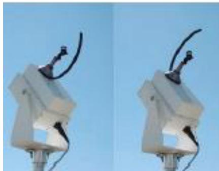
**Figura 1.12** Radiómetro de sombra de banda (RSR) en posición normal (izquierda) y durante la rotación (derecha) [15]
