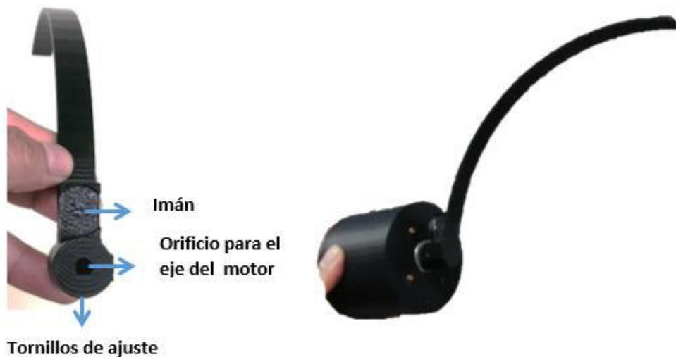
**Figura I.4.** Procedimiento para el montaje de la sombra de banda al eje del motor
