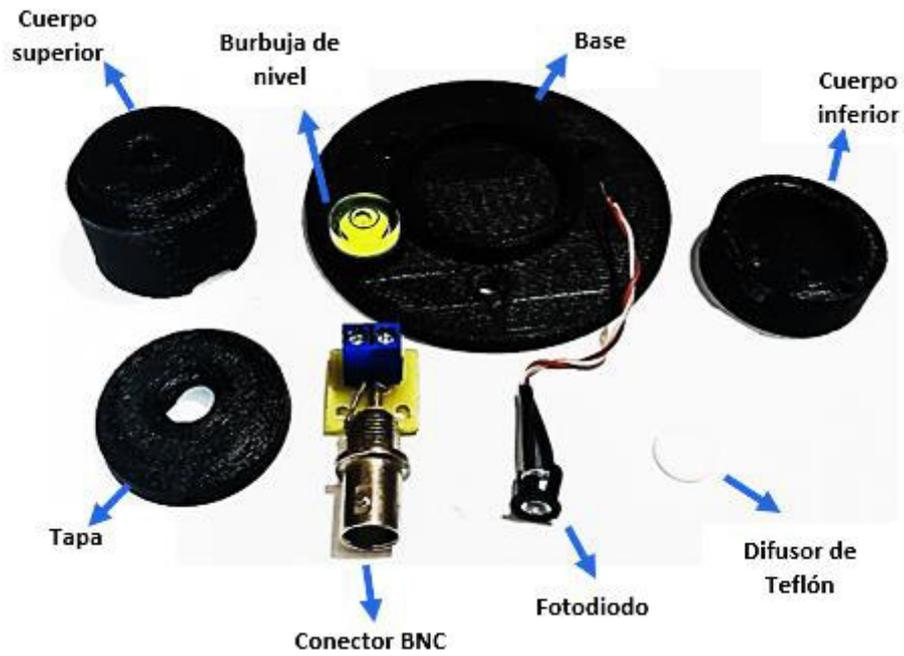
**Figura 3.2** Partes constitutivas del piranómetro implementado
