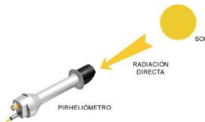
**Figura 1.10** Mediación de DNI con pirheliómetro. [12]
