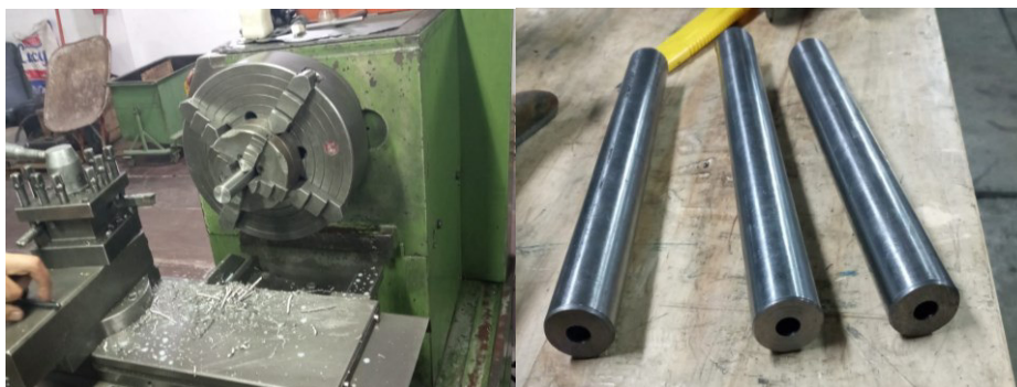
(a) (b) Figura 2.43. a) Maquinado de los ejes. b) Ejes traseros y delanteros. Fuente: Propia
