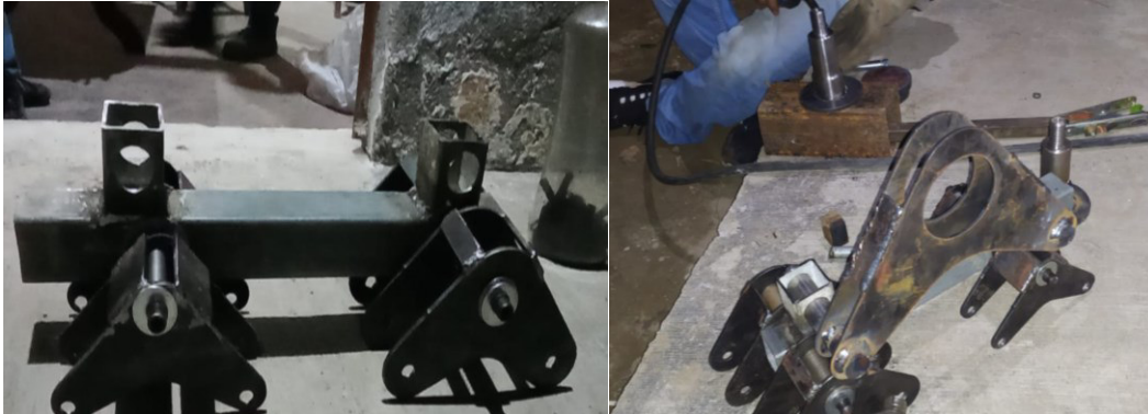
Figura 2.46. Ensamble de la estructura de soporte y bumeranes secundarios. Fuente: Propia
