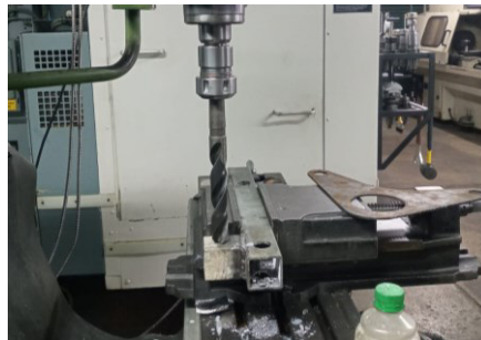
Figura 2.42. Maquinado de los agujeros en el chasis. Fuente: Propia
