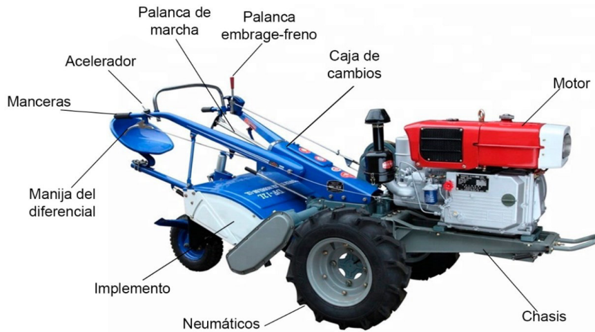
Figura 1.7. Partes y componentes principales del motocultor. Fuente: Manual Mekatech (2015)
