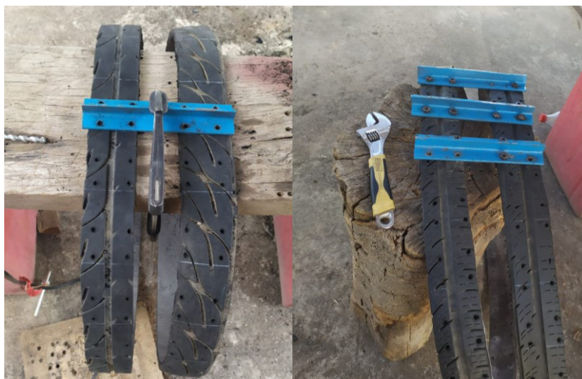
Figura 2.45. Maquinado y ensamble de los dientes de la oruga. Fuente: Propia
