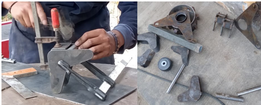
(a) (b) Figura 2.40. a) Bumeranes secundarios. b) Bumeranes principales y secundarios. Fuente: Propia
