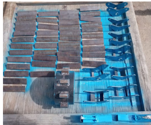
Figura 2.48. Pintura de la estructura y dientes de la oruga. Fuente: Propia
