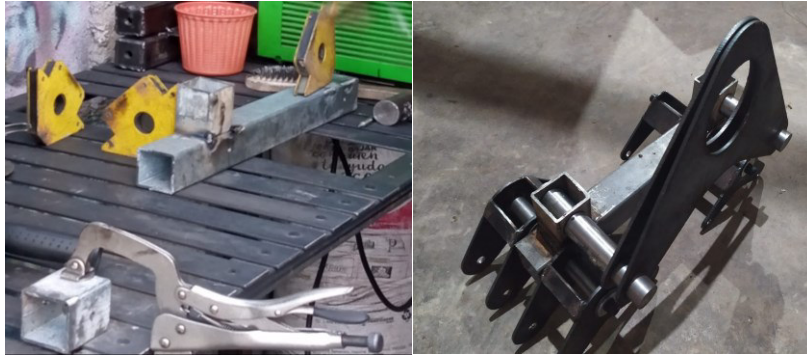
(a) (b) Figura 2.41. a) Estructura principal. b) Chasis con ejes de transferencia y bumeranes. Fuente: Propia
