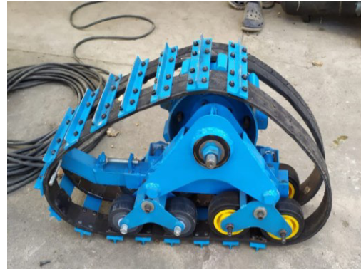
Figura 2.50. Preensamble de banda y rueda motriz. Fuente: Propia
