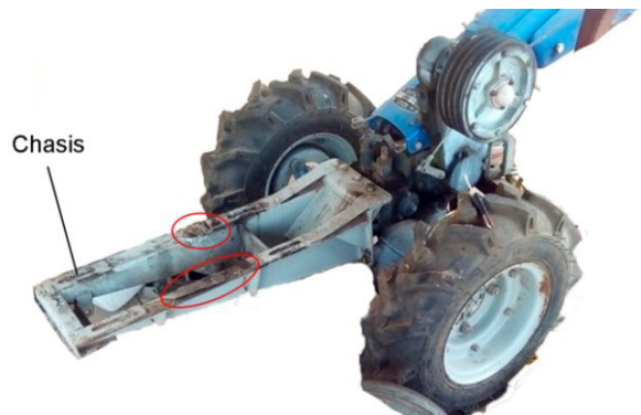
Figura 2.3. Estado del chasis. Fuente: Propia
