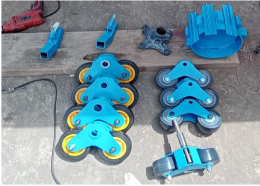
Figura 2.49. Ensamble de ruedas pintadas y ejes. Fuente: Propia
