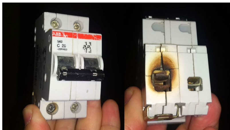
Figura 3.16 Bornes de Interruptor termomagnético quemado.[4]
