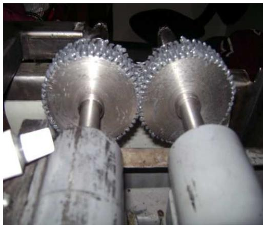
**Figura 5.4.-** Prueba con pulimento permatex
