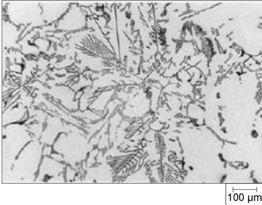
Figura 1.3 Microestructura típica de Al con Si hipoeutéctico (Fuente: [7])
