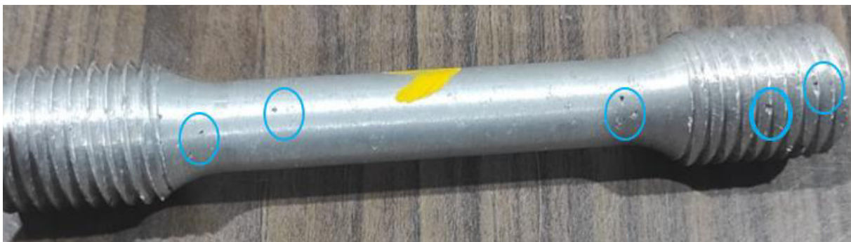
Figura 3.2 Porosidad presente en la probeta del ensayo de tracción. (Fuente: Propia)
