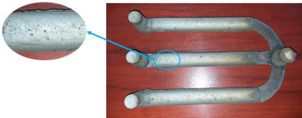
Figura 3.1 Porosidad presente en la pieza fundida (Fuente: Propia)
