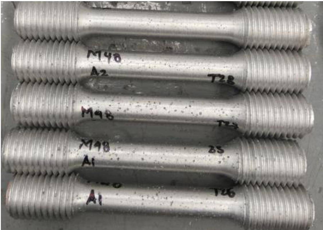
Figura 2.1 Probetas de tracción obtenidas en el proyecto de investigación de Mendoza y Oña (Fuente: [18])
