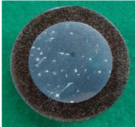
Figura 3.3 Porosidad presente en la probeta del ensayo de microestructura (Fuente: Propia)
