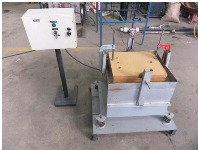
Figura 2.7 Molde horizontal para colado dinámico. (Fuente: Propia)
