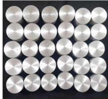
Figura 2.21 Probetas obtenidas del mecanizado de las piezas cilíndricas. (Fuente: Propia)
