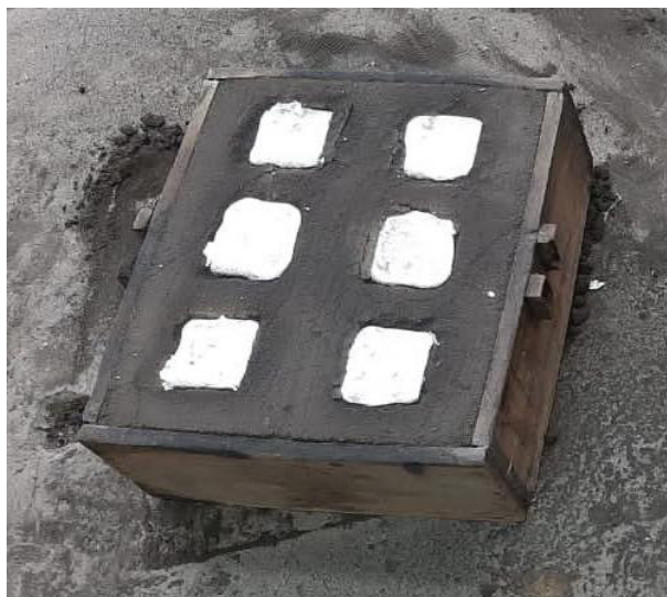
Figura 2.18 Fundición de lingotes cúbicos. (Fuente: Propia)
