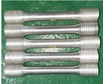
Figura 2.21 Probetas obtenidas del mecanizado de las piezas cilíndricas. (Fuente: Propia)
