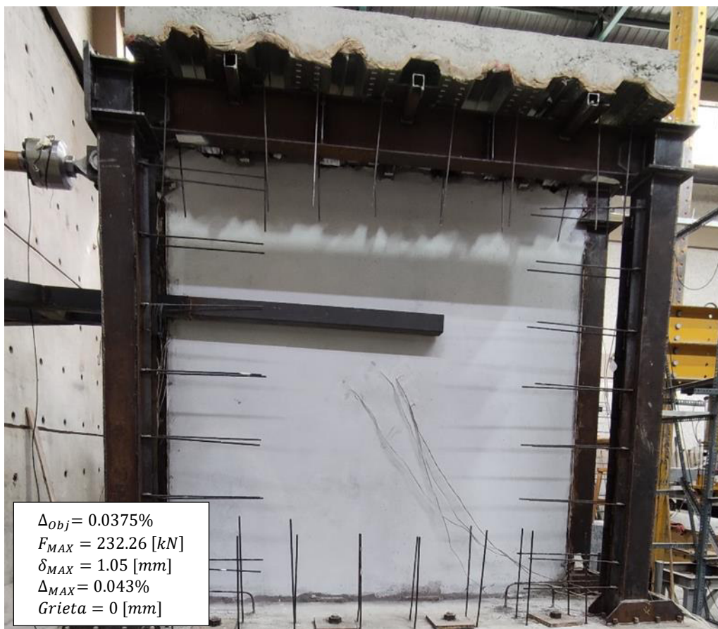
Figura 124. Etapa “Sin daño” de pórtico reforzado con daño previo de mampostería.
