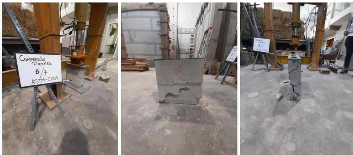
Figura 70. Modo de falla. Probeta 6
