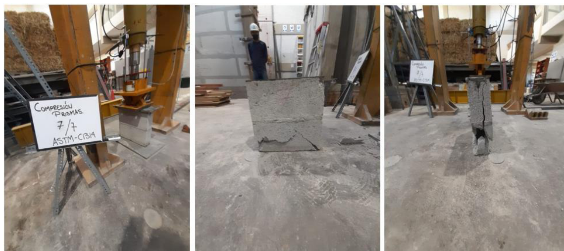
Figura 71. Modo de falla. Probeta 7.
