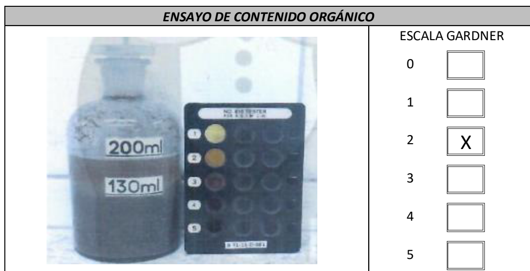
Figura 56. Resultados ensayo de Contenido Orgánico con INEN 855
