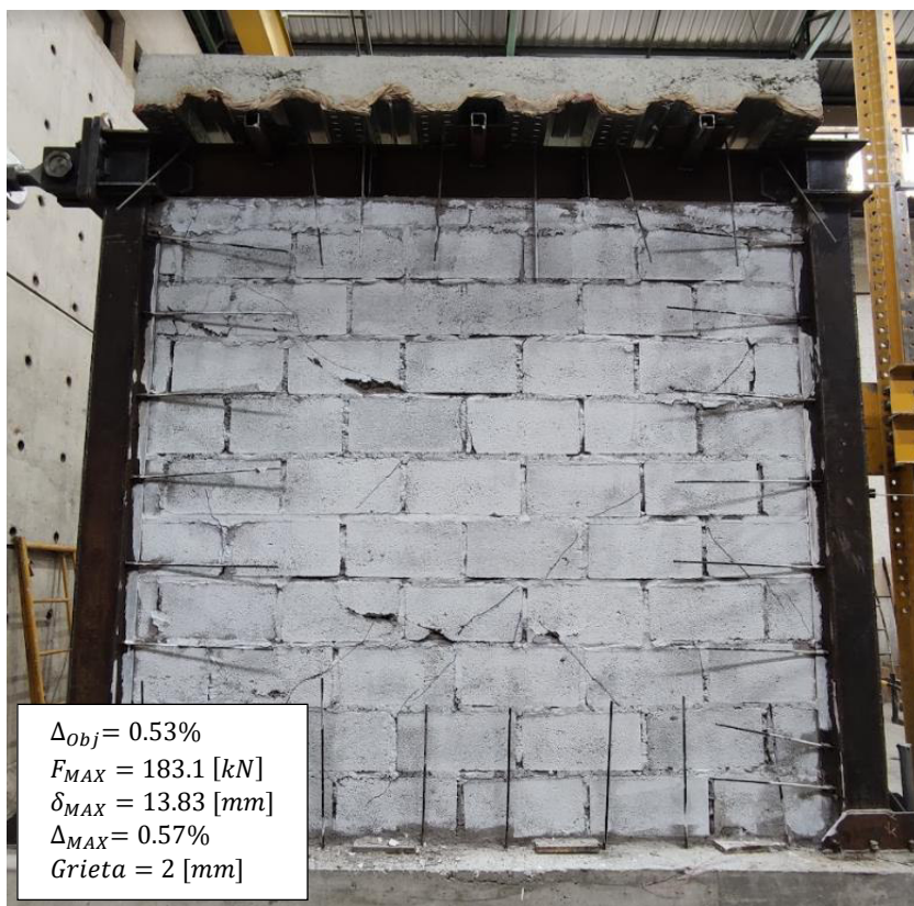
Figura 123. Etapa “Daño Moderado” de pórtico con panel de relleno.
