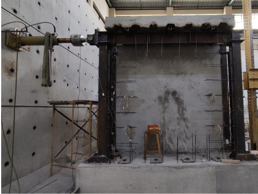
Figura 120. Ensayo de pórtico vacío. Elaborado: Mosquera&Rosero (2021)
