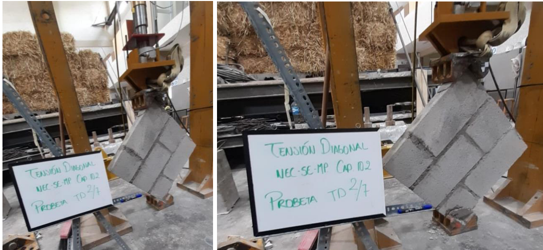
Figura 60. Modo de falla. Probeta 2
