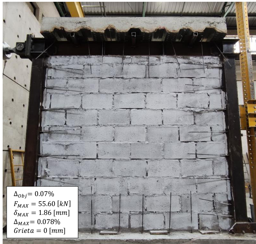
Figura 121. Etapa “Sin daño” de pórtico con panel de relleno.
