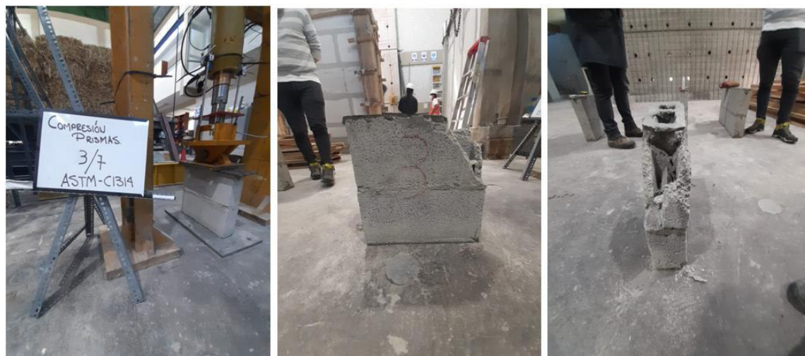
Figura 67. Modo de falla. Probeta 3.
