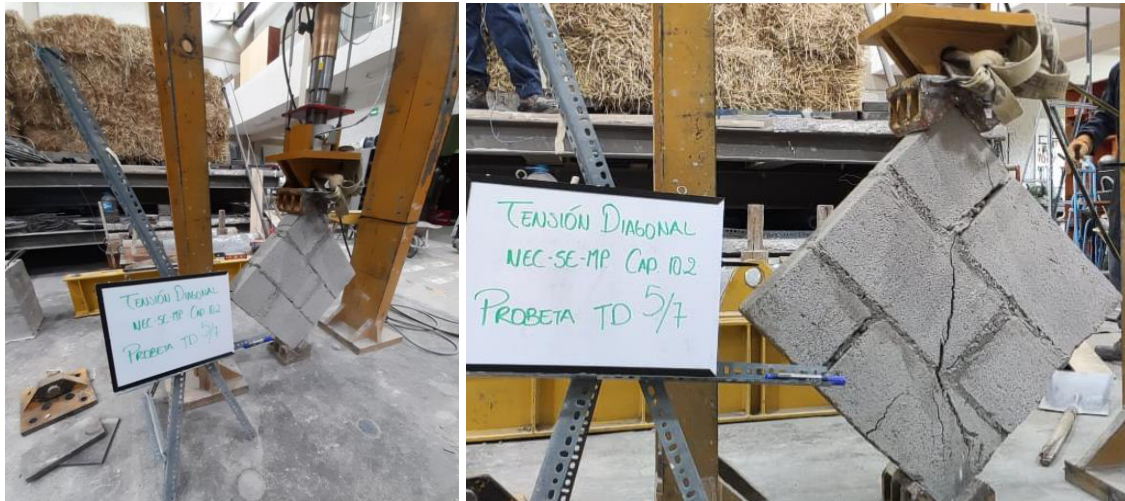
Figura 63. Modo de falla. Probeta 5
