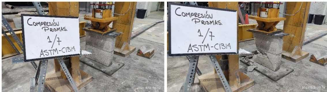
Figura 65. Modo de falla. Probeta 1
