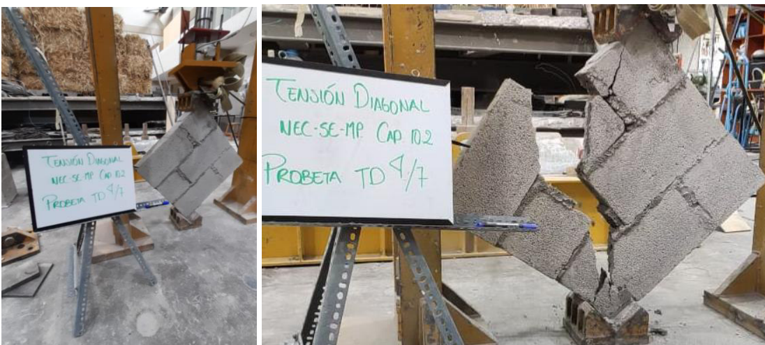
Figura 61. Modo de falla. Probeta 3
