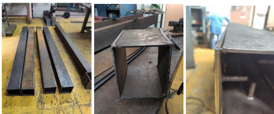
Figura 101. Biselado en columna y conexión de pórtico.
