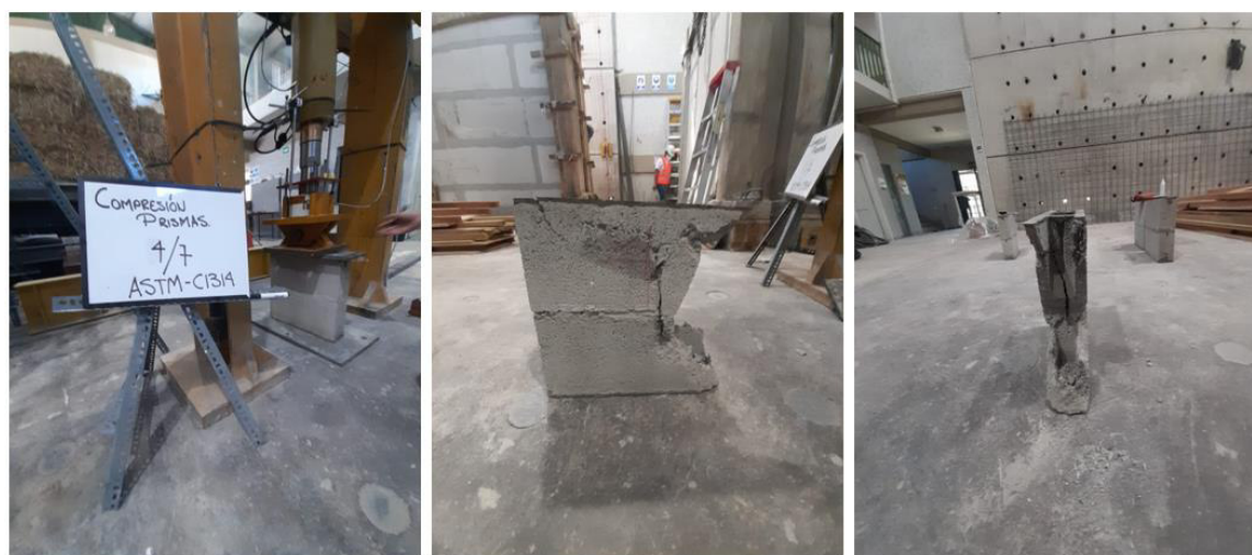
Figura 68. Modo de falla. Probeta 4.
