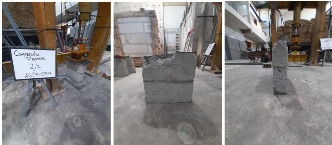
Figura 66. Modo de falla. Probeta 2.
