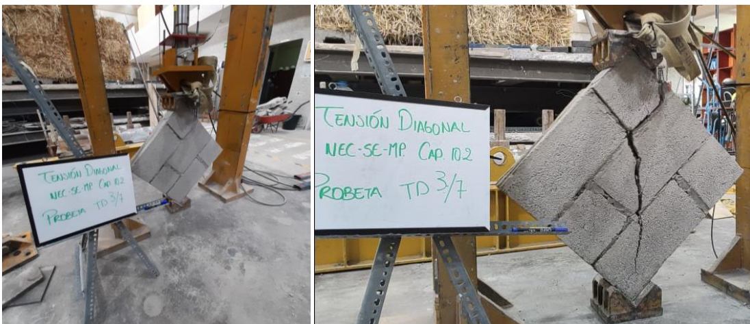
Figura 61. Modo de falla. Probeta 3
