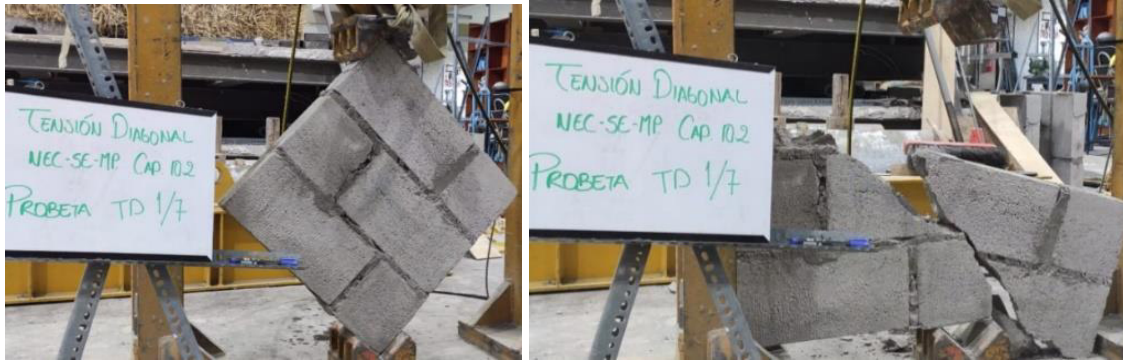
Figura 58. Modo de falla. Probeta 1
