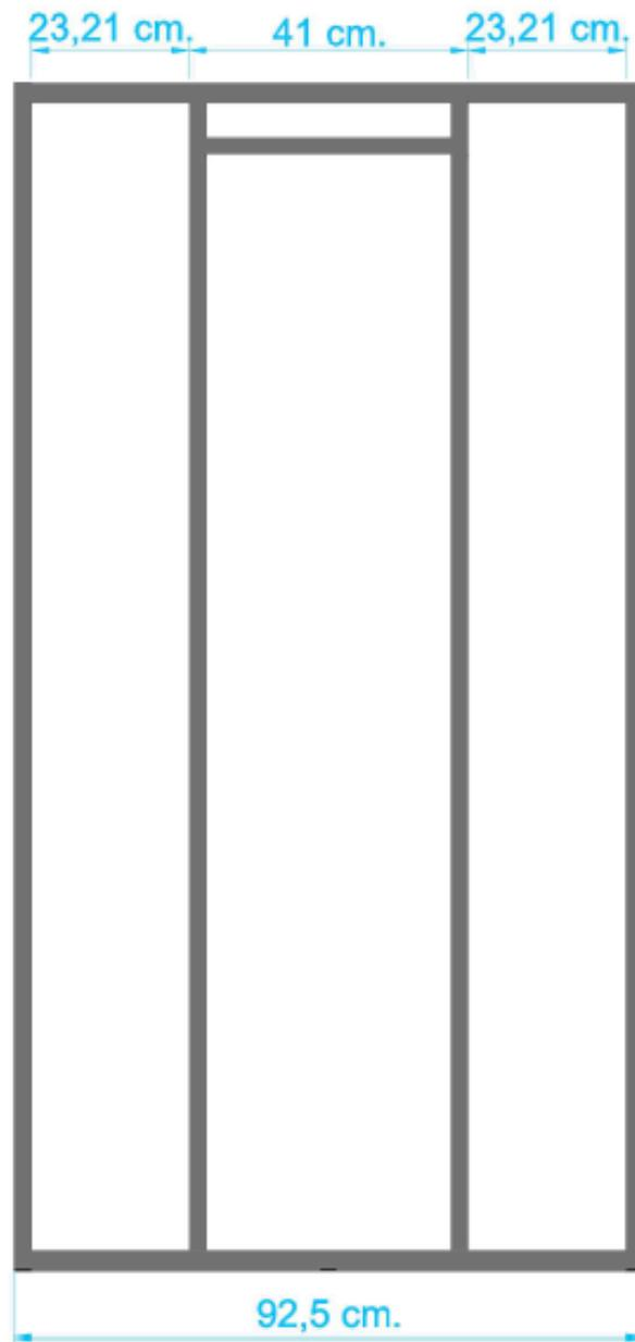
**Figura 0.2** Estructura interna – Vista Lateral
