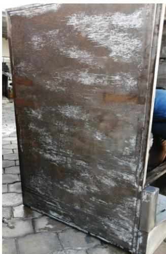
**Figura 3.5** Pared lateral realizada el proceso de chorreado.
