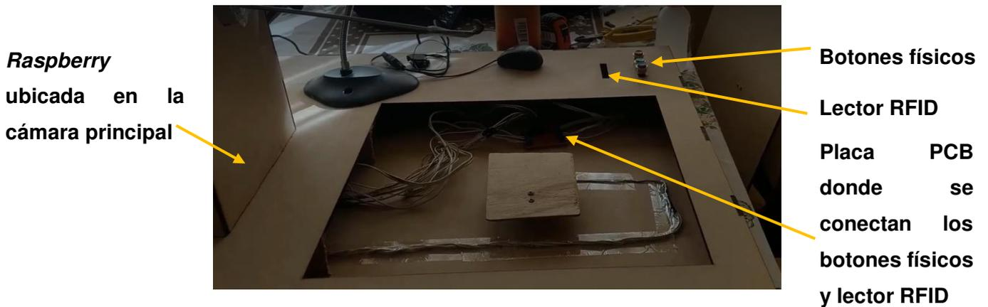
**Figura 3.32** Cableado delantero sin canaletas
