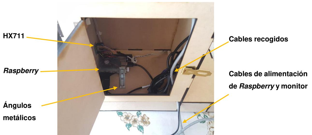
**Figura 3.35** Cableado posterior recogido, *Raspberry* y dispositivos restantes fijados
