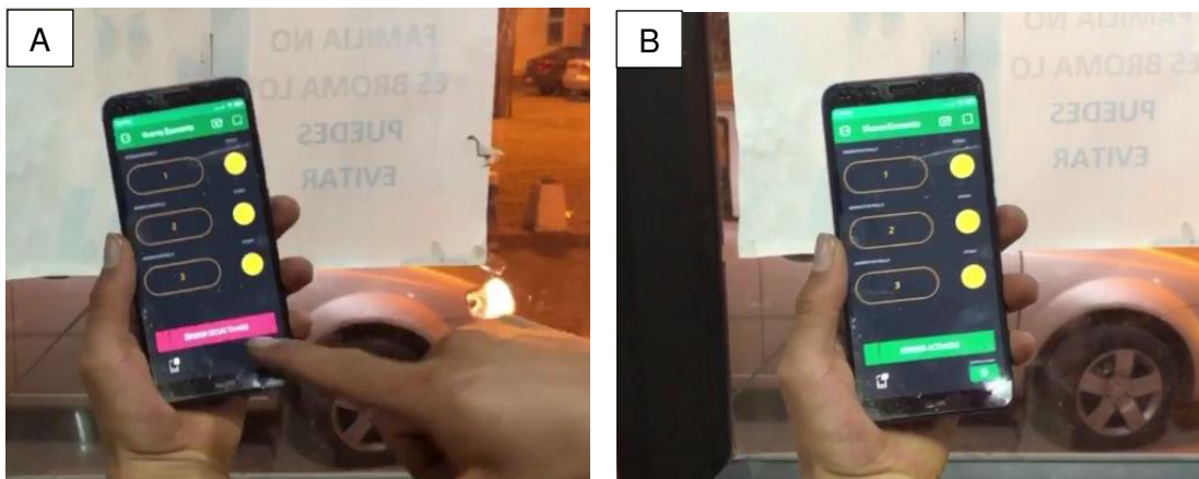
Figura 3.101 Control del sensado de la puerta por aplicación Blynk
