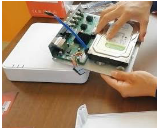
Figura 3.28 Instalación del disco duro en el NVR
