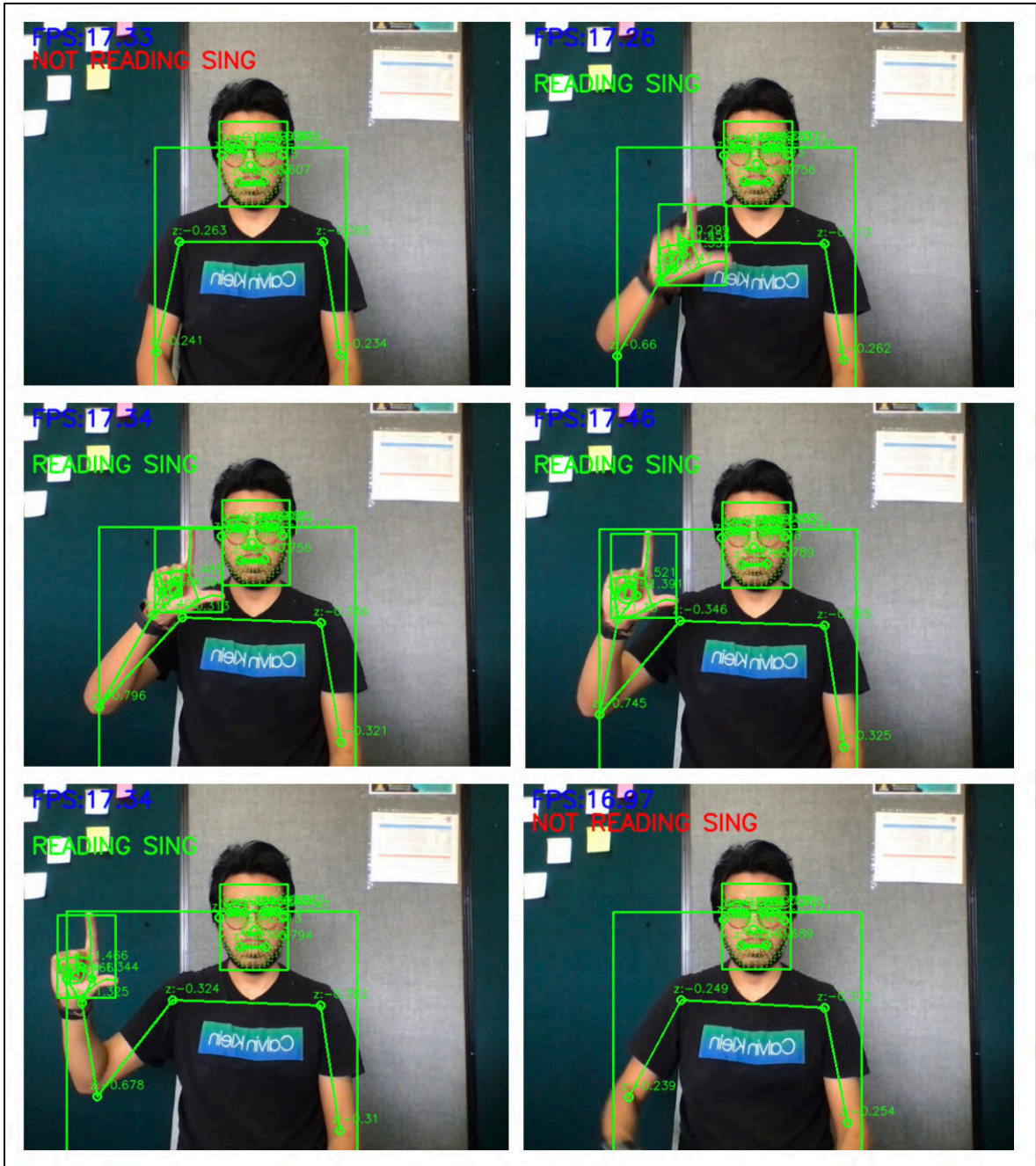
Figura 63. Aplicación del modelo MediaPipe Holístico en una secuencia de frames correspondientes a la gesticulación de la señal LEFT.
