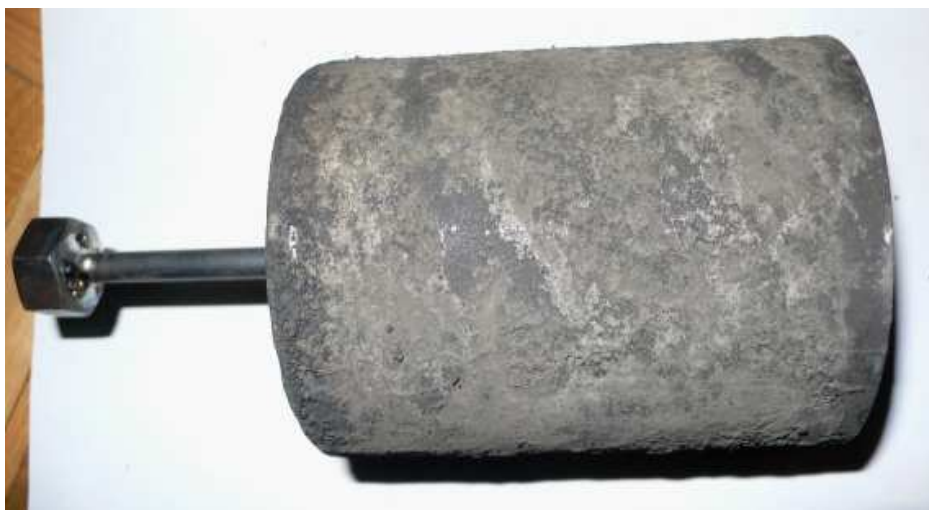
Figura 4.7 Cátodo expuesto al baño electrolítico de la segunda prueba
