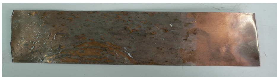
Figura 4.5 Placa de cobre sumergida en químico de desecho antes del baño electrolítico de segunda prueba
