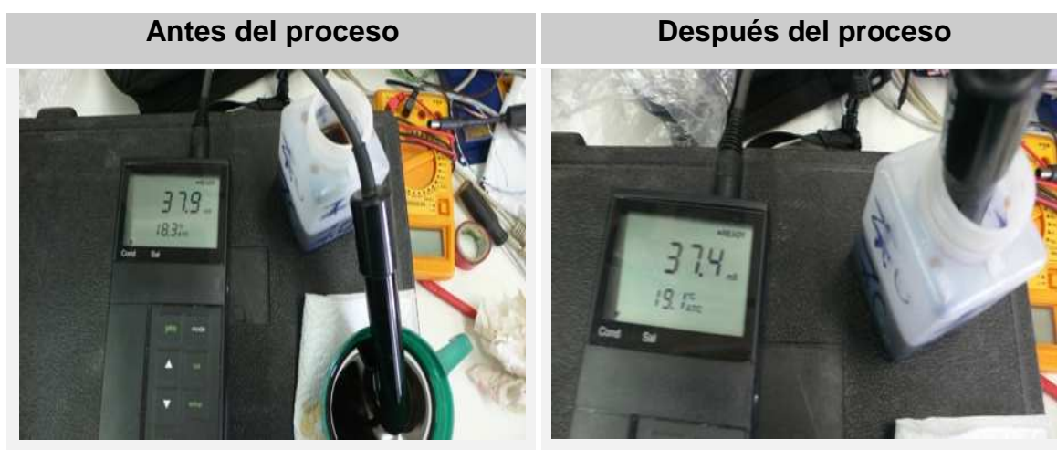
Figura 4.4 Medición de la Conductividad del químico de desecho de la prueba 1
