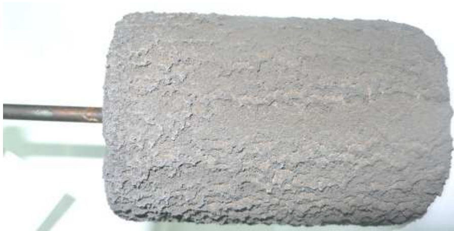
Figura 4.16 Cátodo expuesto al baño electrolítico de la séptima prueba
