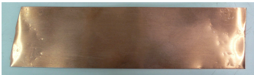
Figura 4.8 Placa de cobre sumergida en químico de desecho después del baño electrolítico de segunda prueba
