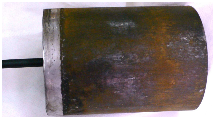
Figura 4.2 Cátodo expuesto al baño electrolítico de la primera prueba
