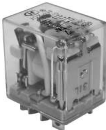
Figura 2.28 Relé de 2 contactos utilizado en el prototipo.
