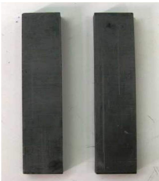
Figura 2.4 Electrodo de grafito fabricado en INDUCARBONES
