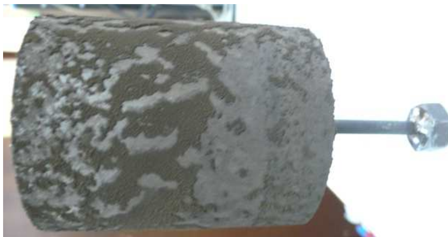
Figura 4.15 Cátodo expuesto al baño electrolítico de la sexta prueba
