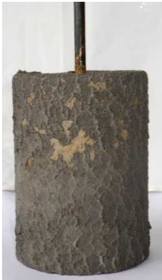
Figura 4.11 Cátodo expuesto al baño electrolítico de la cuarta prueba
