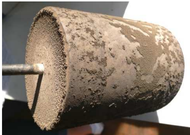
Figura 4.14 Cátodo expuesto al baño electrolítico de la quinta prueba
