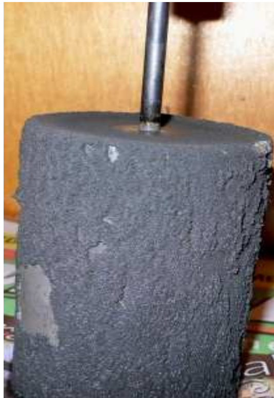
Figura 4.10 Cátodo expuesto al baño electrolítico de la tercera prueba
