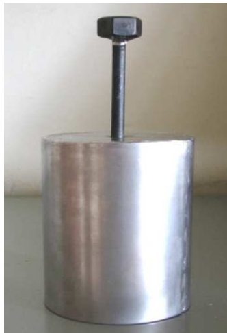
Figura 2.2 Cátodo construido en acero de 1½ pulgadas de espesor
