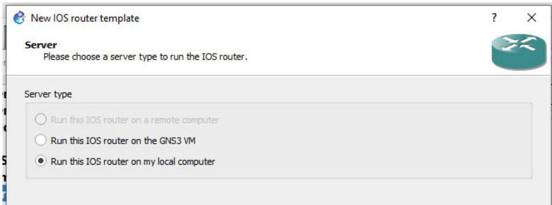
Figura 3.90 Tipo del servidor en el que se ejecutará la Imagen del router Cisco.
