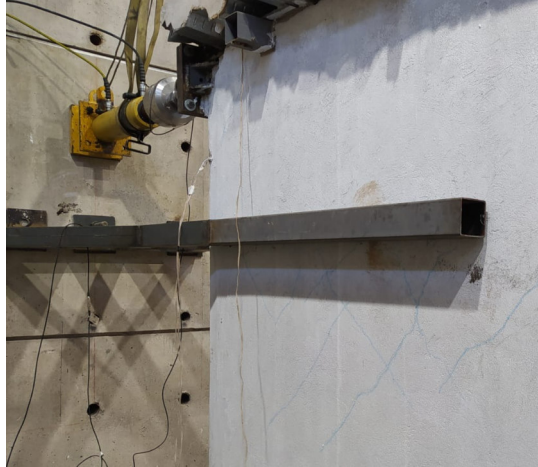
Figura 101. Mecanismo de apoyo lateral del prototipo en el caso de estudio 4. Elaborado: Játiva & Torres (2021).
