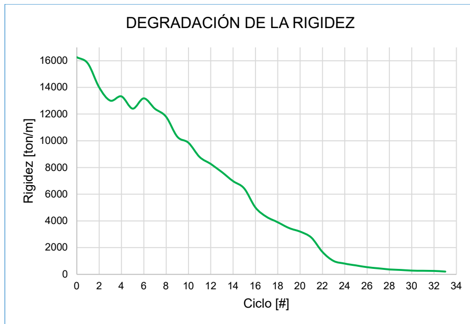
Figura 107. Diagrama de degradación de rigidez para el caso de estudio 4.
