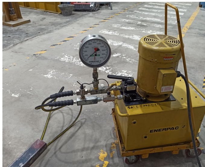
Figura 35. Bomba y mangueras para aplicación de carga (ENERPAC).
