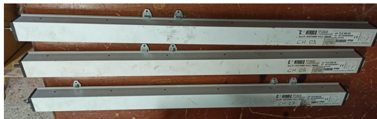
Figura 36. LVDT del sistema de medición de deformaciones.
