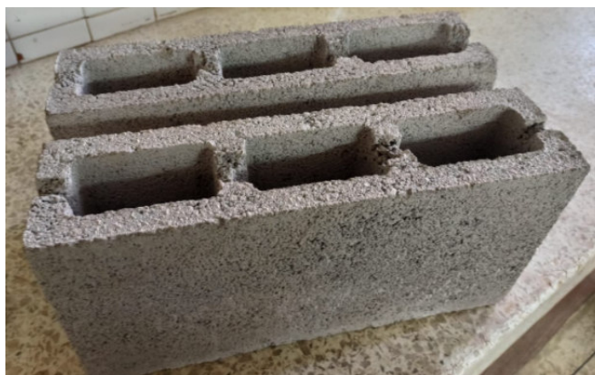
Figura 21. Muestras de bloque hueco de hormigón.
