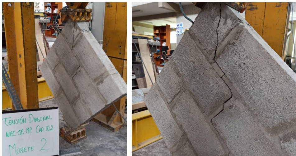
Figura 32. Esquema general del ensayo (detalle del modo de falla del Murete 2). Elaborado: Játiva & Torres (2021).
