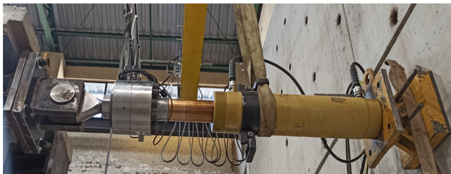
Figura 34. Gato hidráulico en acción, celda de carga lateral y placa de acople.
