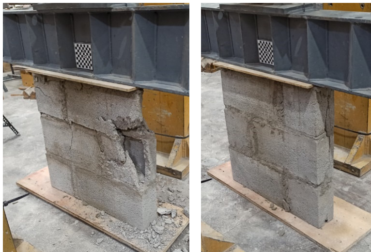
Figura 29. Falla en cono y grietas verticales en muretes a compresión.
