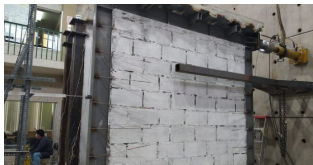
Figura 92. Mecanismo de apoyo lateral del prototipo en el caso de estudio 3.
