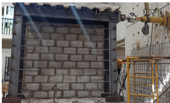
Figura 76. Configuración de equipos para ensayo de prototipos.
