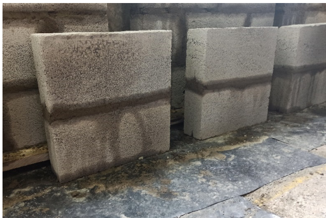
Figura 25. Prismas de mampostería para compresión estándar.
