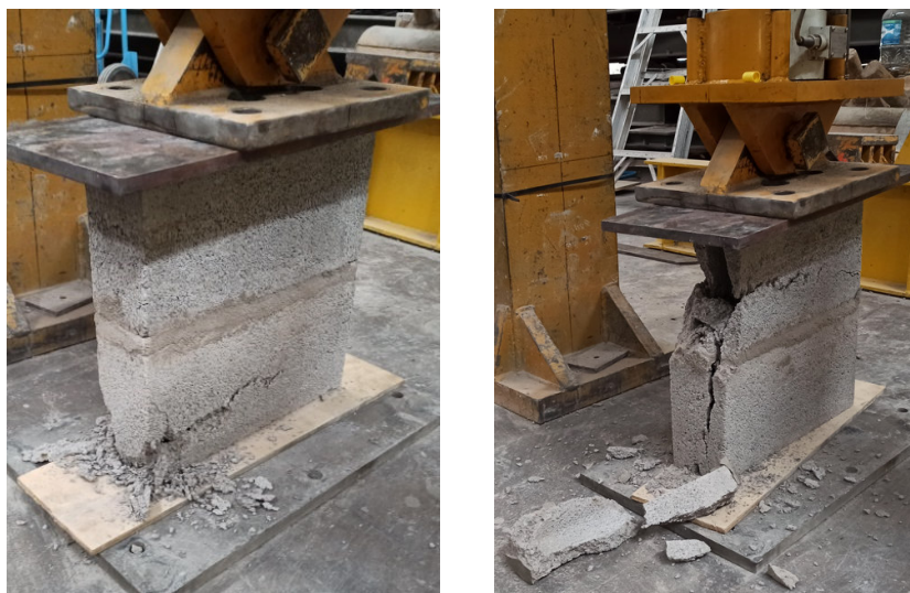
Figura 26. Esquema general del ensayo (Modo de falla del Prisma 3 y 5).
