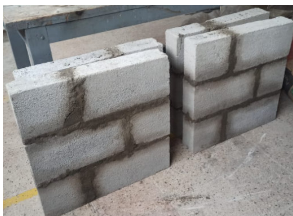
Figura 28. Muretes de mampostería para compresión estándar.
