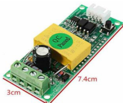
Figura 3.9 Módulo PZEM-004 a 100A [9].
