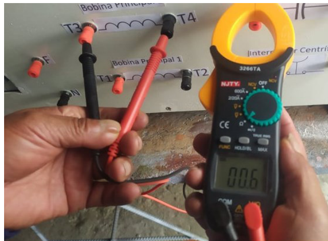
Figura 3.18 Prueba de resistencias bobinado.
