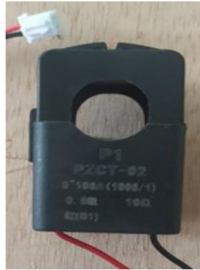
Figura 3.10 Pinza amperimétrica de 100(A).
