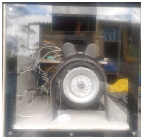
Figura 3.16 Motor monofásico montado en la estructura.
