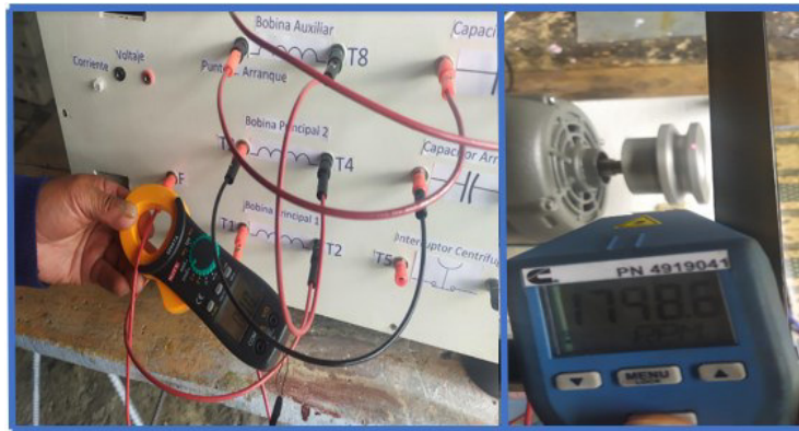
Figura 3.21 Multímetro y tacómetro utilizado para la medición de valores.
