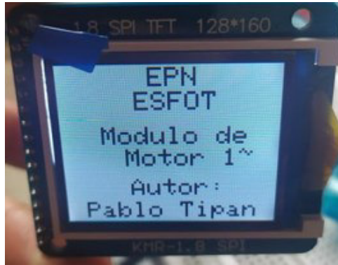
Figura 3.12 Pantalla SPI TFT 1.8”.
