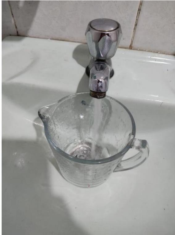
**Figura 8.** Medición del caudal del lavamanos (método volumétrico)
