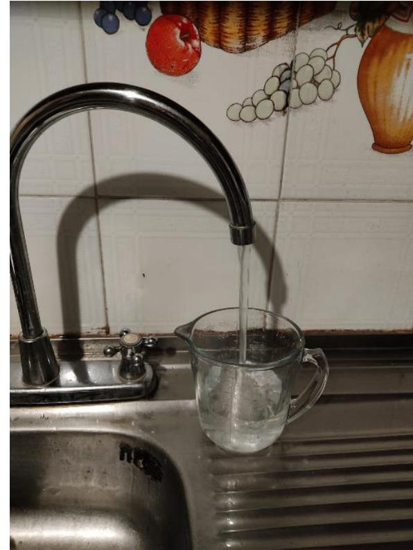
**Figura 9.** Medición del caudal de llave de la cocina (método volumétrico)
