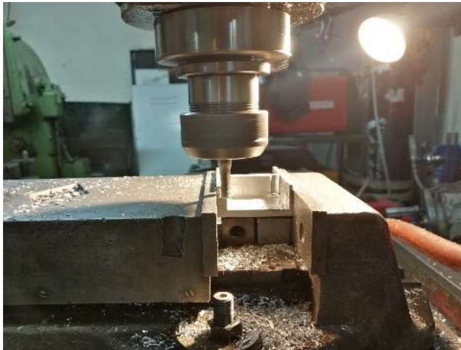
Figura 3.38 Fabricación de soporte para imanes.
