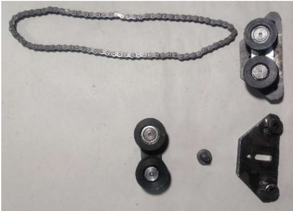
Figura 3.41 Construcción de templadores de cadena
