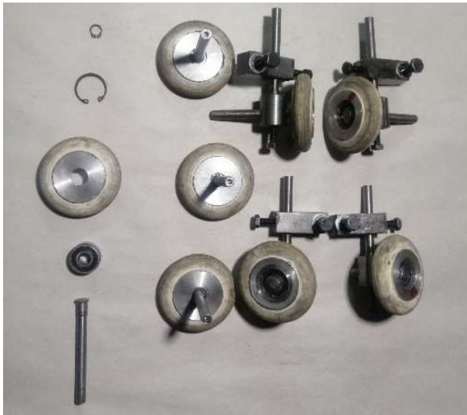
Figura 3.40 Construcción de ruedas de apoyo.
