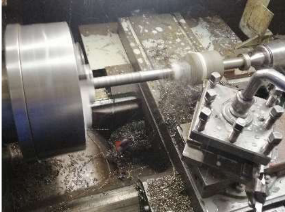
Figura 3.39 Construcción de poleas en duralón.
