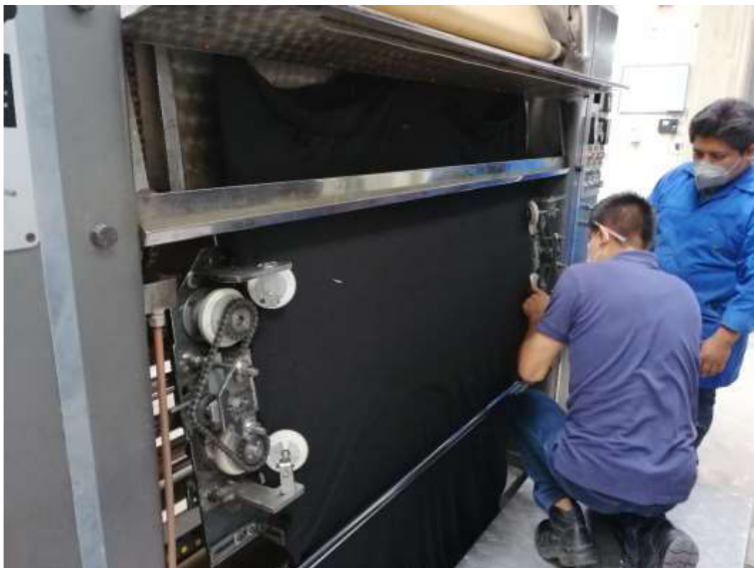
Figura 3.55 Prueba N°3 Estabilización del nuevo sistema de expansión.
