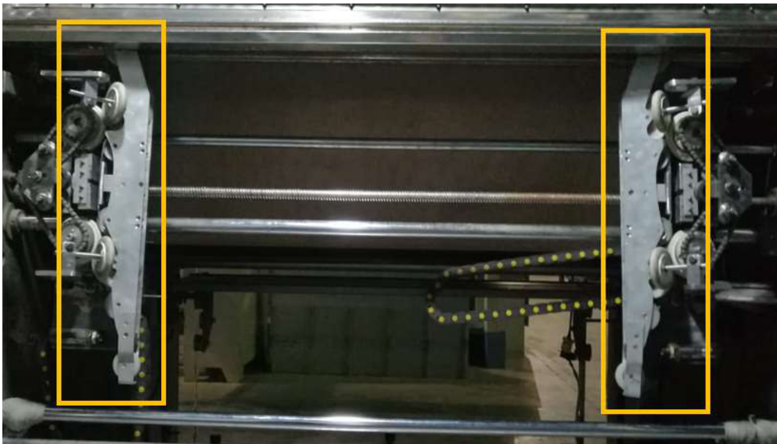
Figura 3.52 Fijación de expander y ruedas de estabilización.
