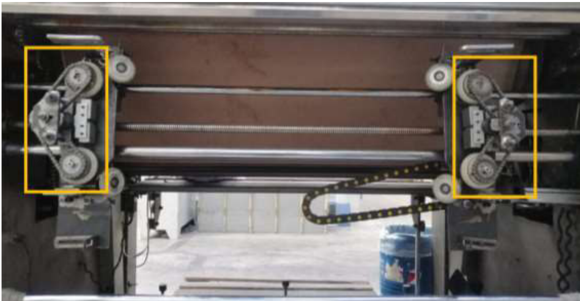
Figura 3.51 Montaje de transmisión de sistema de expansión.
