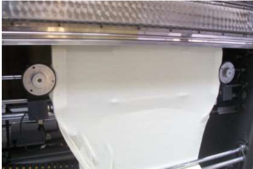
Figura 1.3 Ingreso de tela hacia los cilindros de planchado
