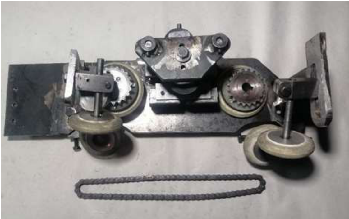
Figura 3.43 Estructura de soporte del sistema de expansión.
