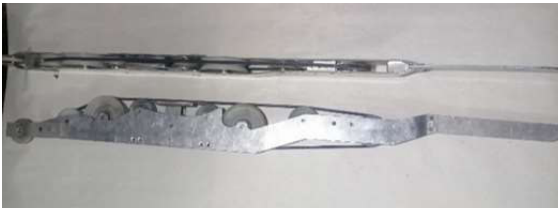
Figura 3.44 Construcción de los expansores.
