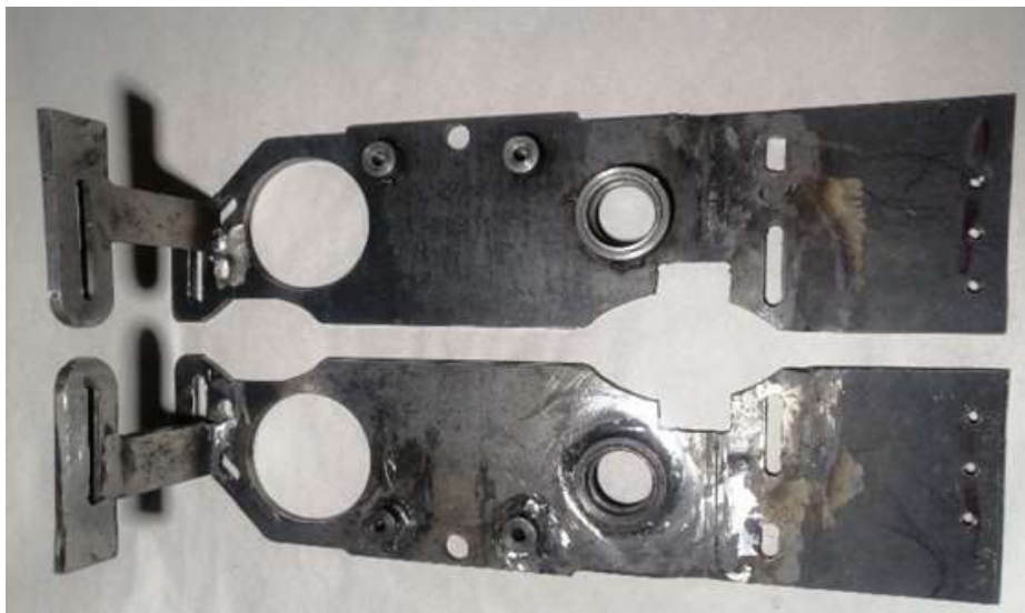
Figura 3.36 Fabricación de las bases de soporte para el sistema de expansión
