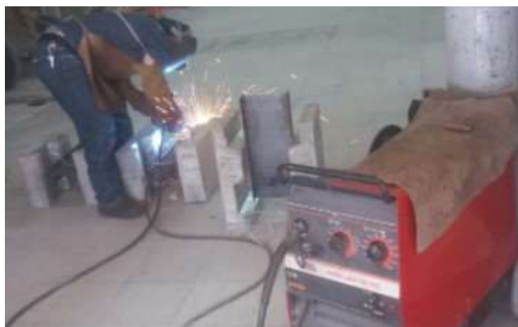
Figura 42. Conformación de perfil I
