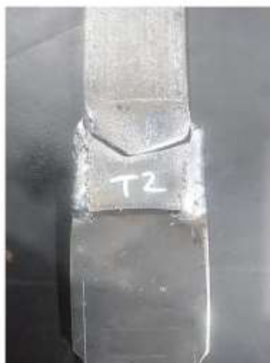
Fotografía 4. Probeta M21.064.02 después del ensayo de tracción.
