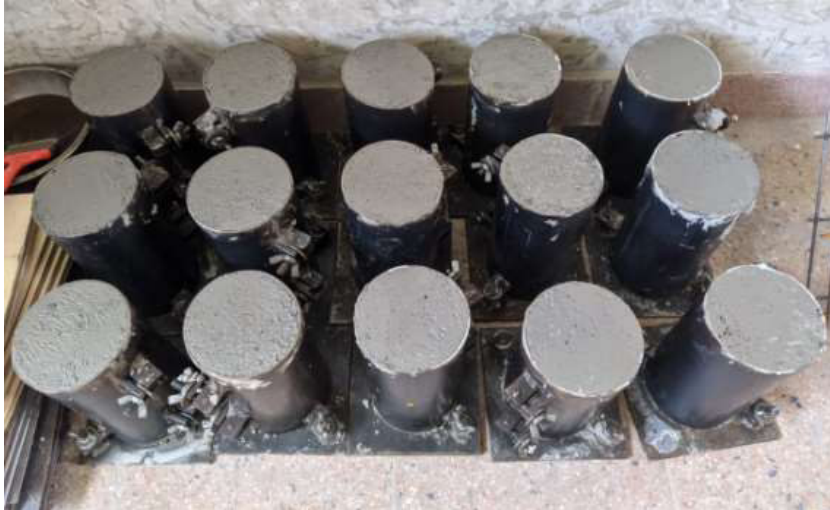
Figura 39. Cilindros de hormigón
