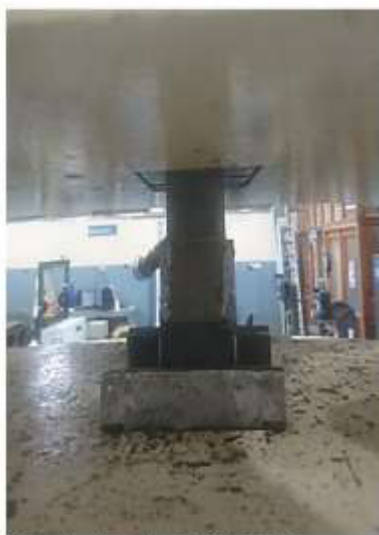
Fotografía 3. Montaje de la probeta M21.064.02 para ensayo de tracción.
