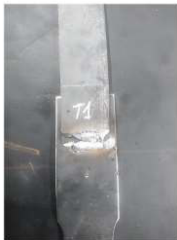
Fotografía 2. Probeta M21.064.01 después del ensayo de tracción.
