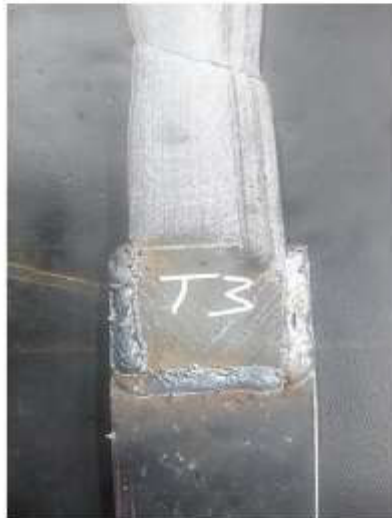
Fotografía 6. Probeta M21.064.03 después del ensayo de tracción.
