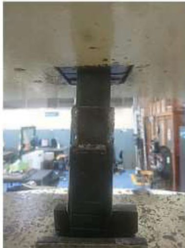
Fotografía 5. Montaje de la probeta M21.064.03 para ensayo de tracción.
