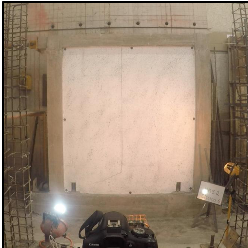
Foto 33. Fisuras Ciclo 6(29) en el MMS 2 (Halado \leftarrow ), \Delta=-7.99\text{mm} ; P=-74.99\text{kN}
