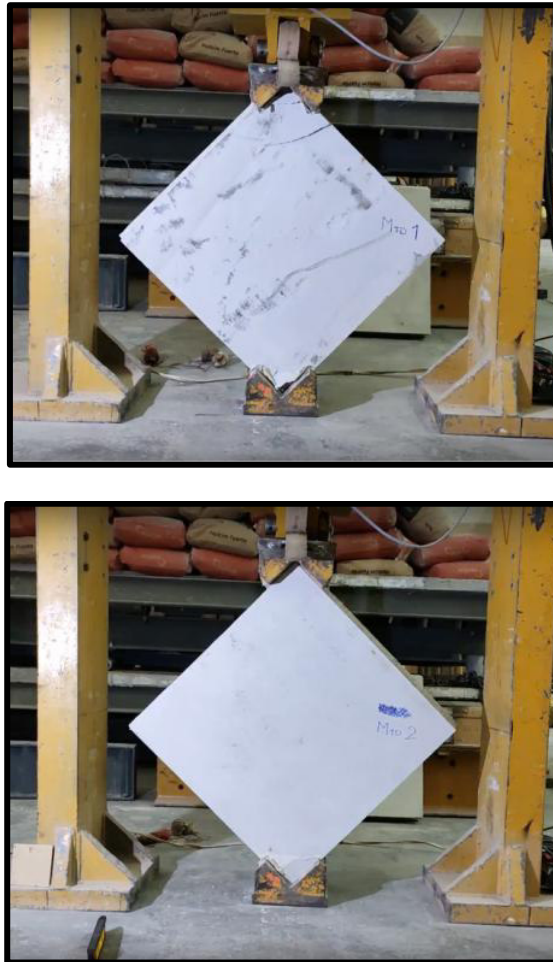
Figura 3.13. Falla debido al aplastamiento en las esquinas conseguido en el ensayo de tracción diagonal.
