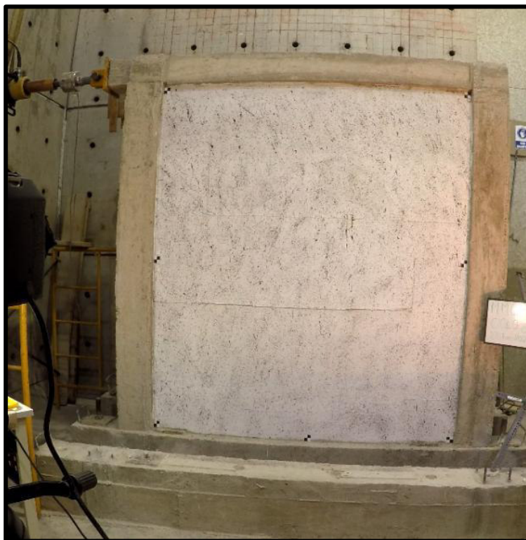
Foto 51. Primera fisura Ciclo 21 en el MMCR 2, (Empuje →), \Delta=8.14\text{mm} ; P=121.09\text{kN}
