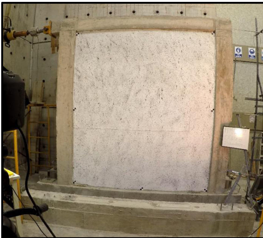
Foto 53. Fisuras Ciclo 6(29) en el MMCR 2 (Halado ←), \Delta=-8.13\text{mm} ; P=-108.29\text{kN}
