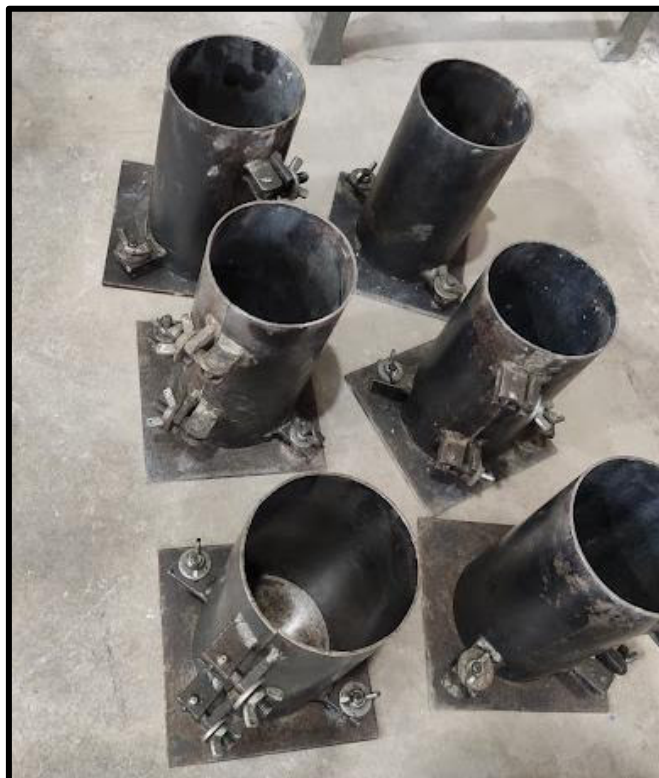
Foto 9. Moldes metálicos cilíndricos para concreto
