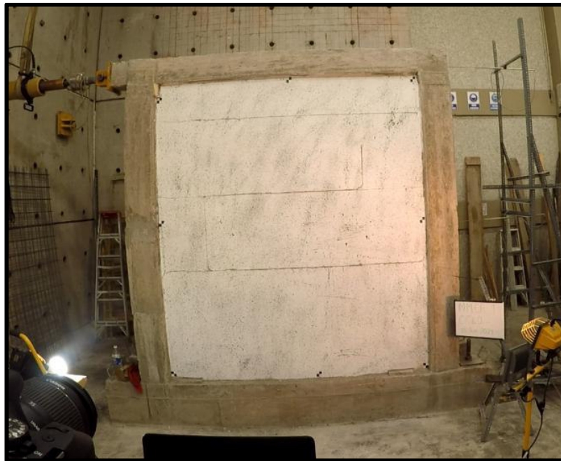
Foto 43. Fisuras Ciclo 7(32) en el MMCR 1 (Halado \leftarrow ), \Delta=-13.67\text{mm} ; P=-98.04\text{kN}
