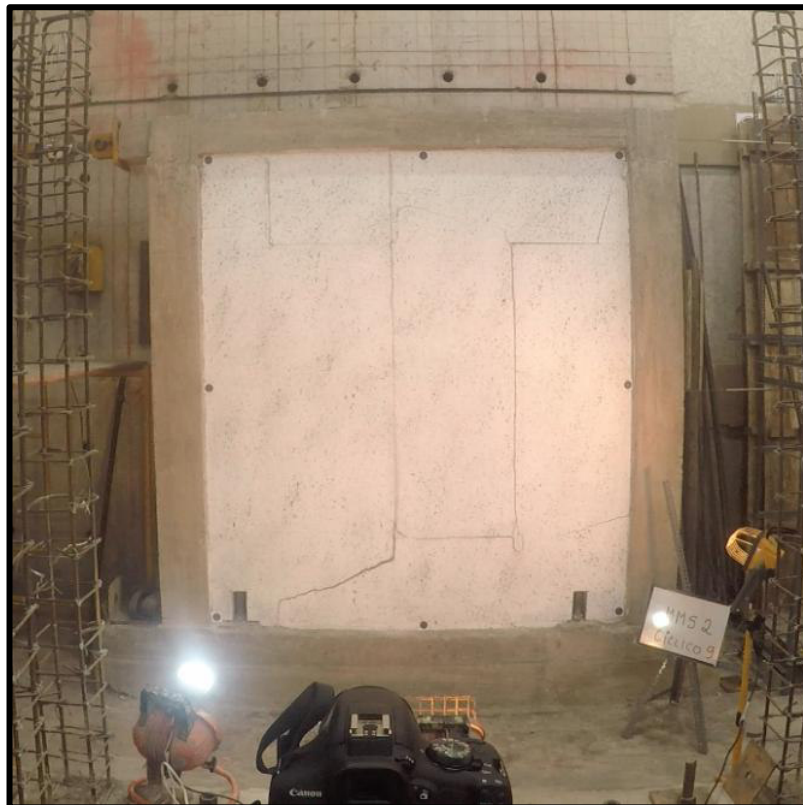
Foto 39. Fisuras Ciclo 9(38) en el MMS 2 (Halado \leftarrow ), \Delta=-30.02\text{mm} ; P=-73.75\text{kN}
