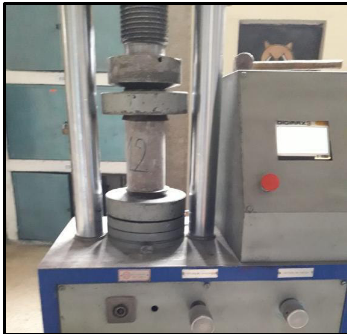
Foto 11. Ensayo de rotura de cilindros de concreto
