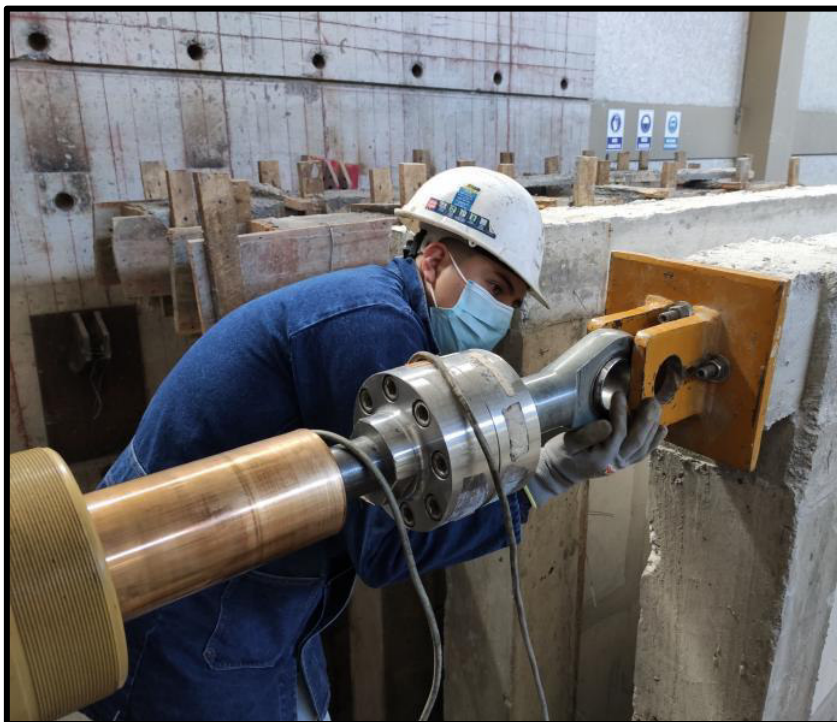
Foto 2. Montaje del émbolo de la celda de carga a la placa hembra con un pasador no roscado
