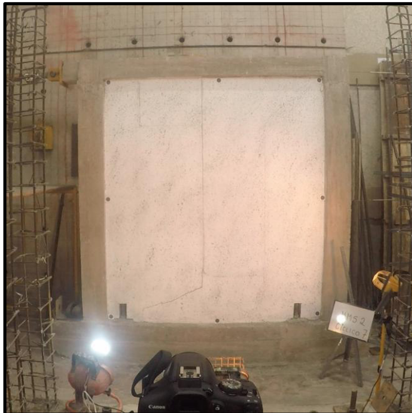
Foto 35. Fisuras Ciclo 7(32) en el MMS 2 (Halado \leftarrow ), \Delta=-13.35\text{mm} ; P=-90.75\text{kN}
