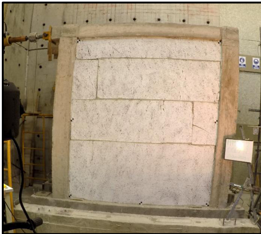
Foto 60. Fisuras Ciclo 12(47) en el MMCR 2 (Empuje →), \Delta=59.22\text{mm} ; P=95.11\text{kN}
