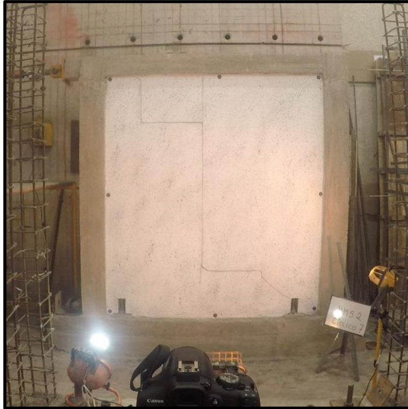
Foto 34. Fisuras Ciclo 7(32) en el MMS 2 (Empuje \rightarrow ), \Delta=13.26\text{mm} ; P=94.85\text{kN}
