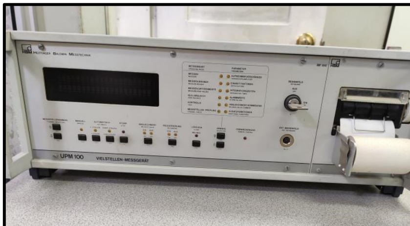
Foto 7. Sistema UPM100 para recopilación y procesamiento de datos de carga y desplazamiento de manera digital
