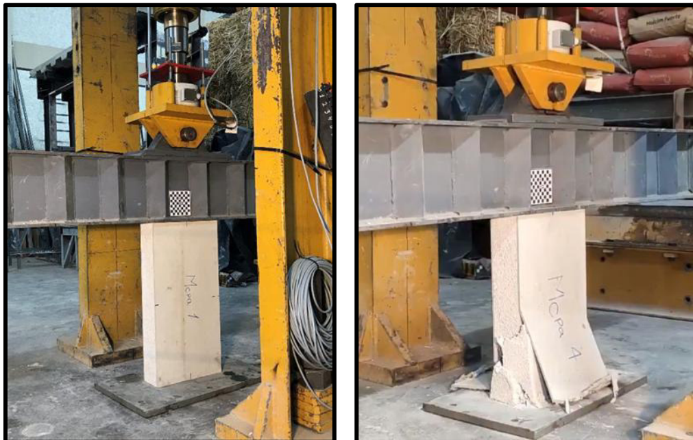
Figura 3.10. Ensayo a compresión paralela
