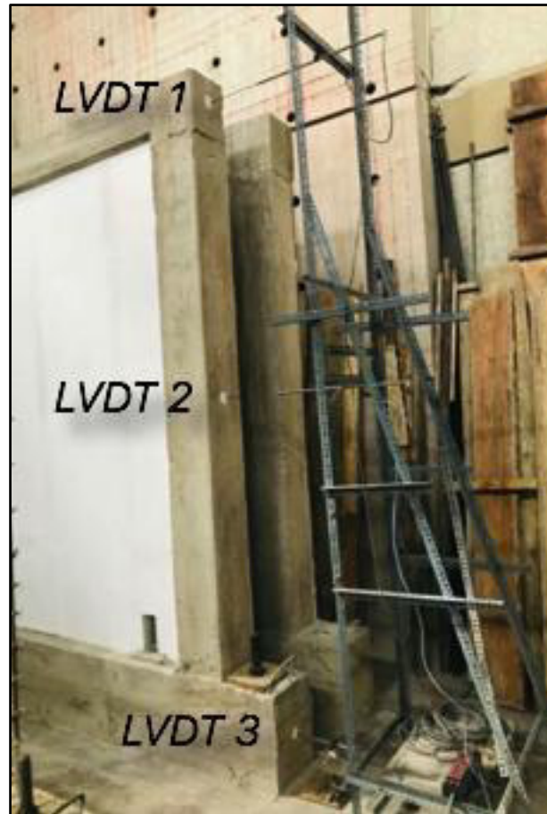
Figura 4.4. Colocación de LVDT's
