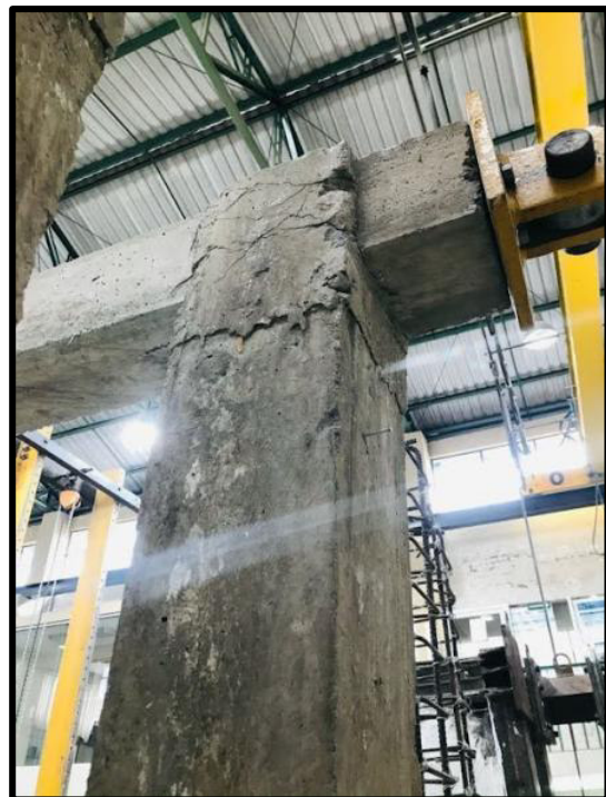
Foto 13. Falla en la conexión viga-columna en el Pórtico
