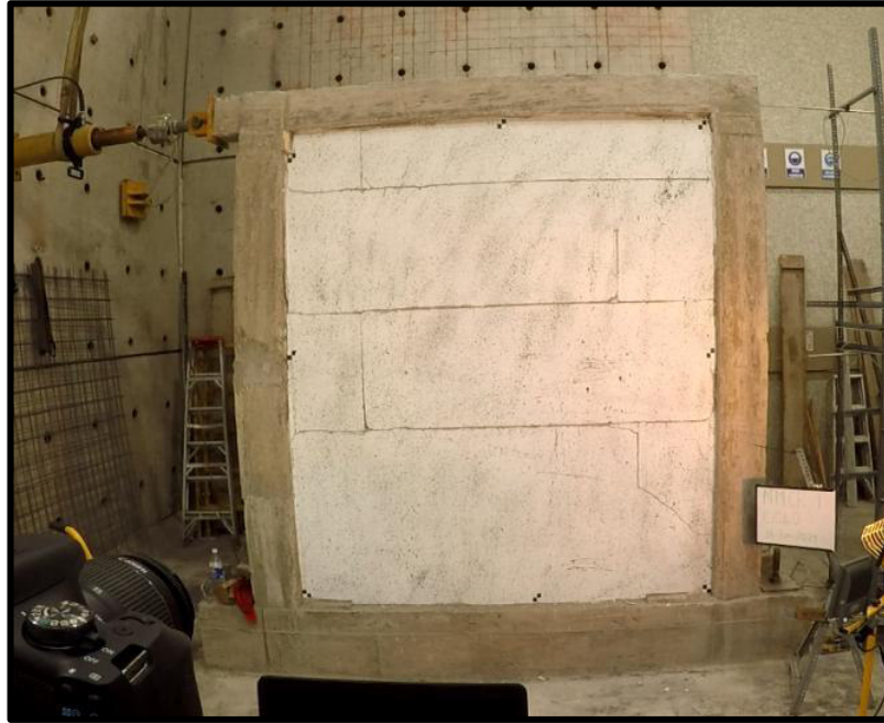
Foto 44. Fisuras Ciclo 9(38) en el MMCR 1 (Empuje \rightarrow ), \Delta=29.16\text{mm} ; P=115.96\text{kN}
