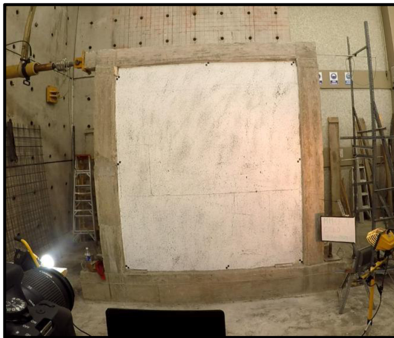
Foto 41. Fisuras Ciclo 5(25) en el MMCR 1(Empuje →), \Delta=5.93\text{mm} ; P=127.41\text{kN}
