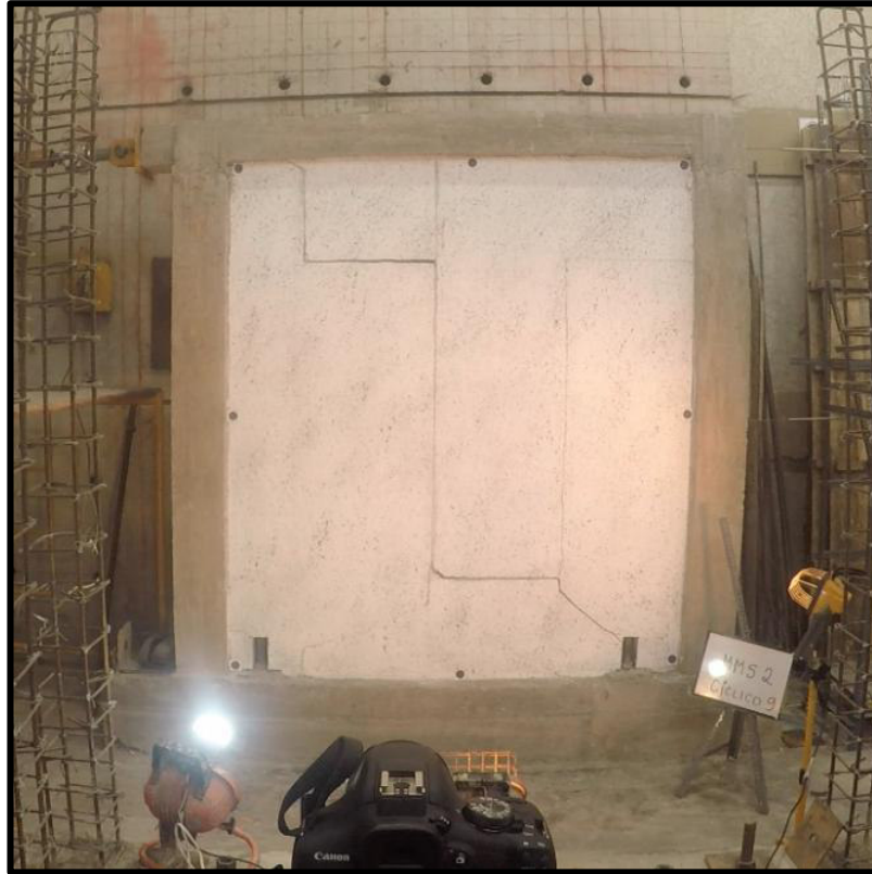
Foto 38. Fisuras Ciclo 9(38) en el MMS 2 (Empuje \rightarrow ), \Delta=31.29\text{mm} ; P=76.07\text{kN}
