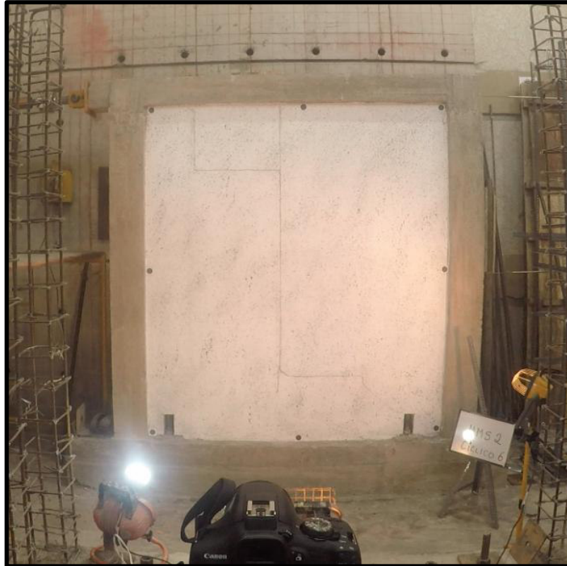
Foto 32. Fisuras Ciclo 6(29) en el MMS 2 (Empuje \rightarrow ), \Delta=7.99\text{mm} ; P=76.41\text{kN}
