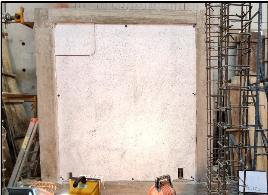
Foto 25. Fisuras Ciclo 41 en el MMS 1 (Halado ←), \Delta=-39.65\text{mm} ; P=-130.80\text{kN}
