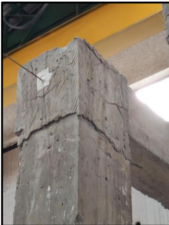
Foto 13. Falla en la conexión viga-columna en el Pórtico
