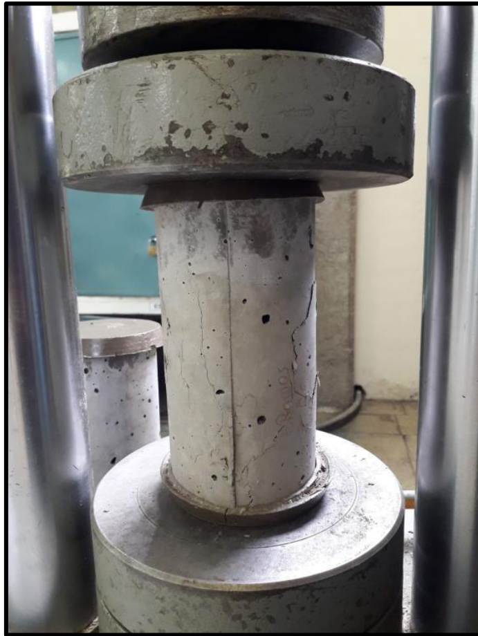
Foto 10. Ensayo de rotura de cilindros de concreto
