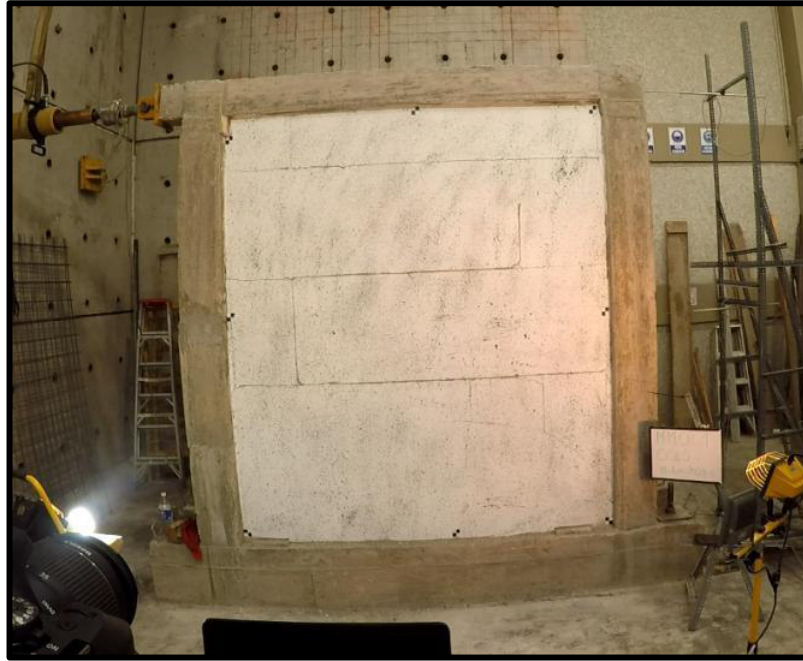
Foto 42. Fisuras Ciclo 7(32) en el MMCR 1 (Empuje \rightarrow ), \Delta=14.05\text{mm} ; P=132.03\text{kN}
