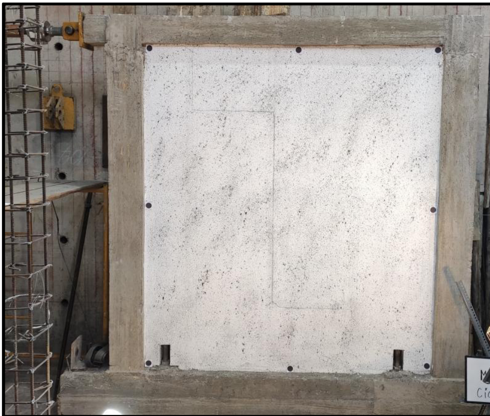
Foto 31. Primera fisura Ciclo 25 en el MMS 2 (Halado ←), \Delta=-6.108\text{mm} ; P=-72.532\text{kN}
