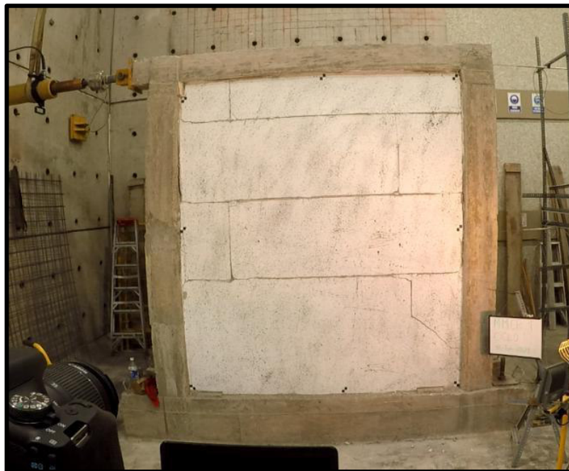
Foto 46. Fisuras Ciclo 10(41) en el MMCR 1(Empuje \rightarrow ), \Delta=43.24\text{mm} ; P=115.96\text{kN}
