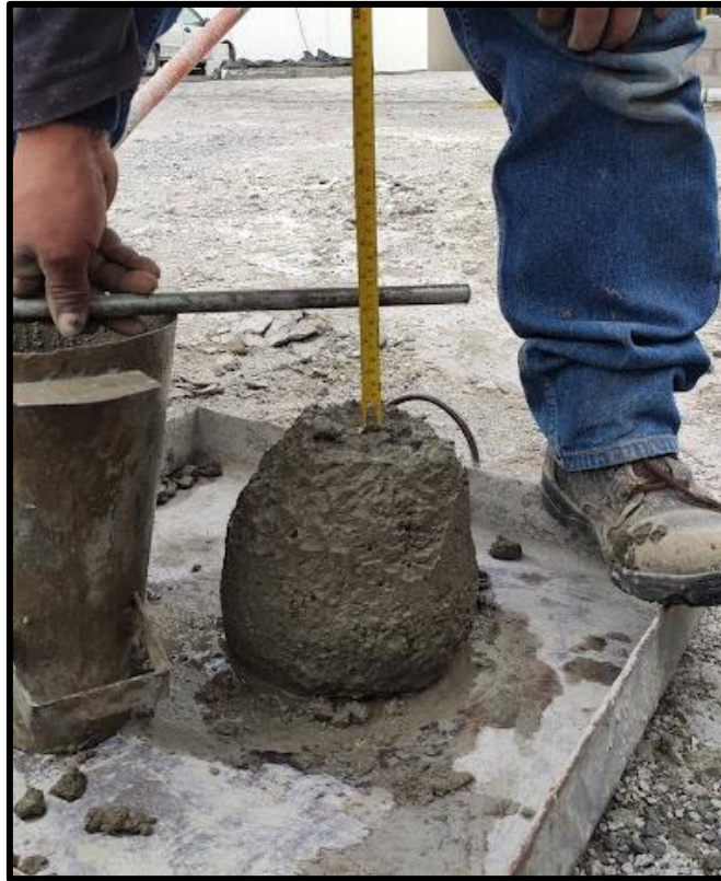
Foto 8. Control de la consistencia del hormigón mediante el Ensayo de Abrams
