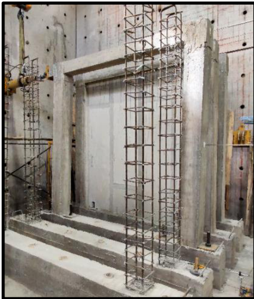
Foto 12. Fisuras Ciclo 14(49) en el Pórtico (Empuje \rightarrow ), \Delta=91.49\text{mm} ; P=27.90\text{kN} (Halado \leftarrow ), \Delta=-90.05\text{mm} ; P=-27.40\text{kN}
