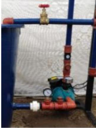
*Figura 3.3 Posición de bomba (succión positiva)*
