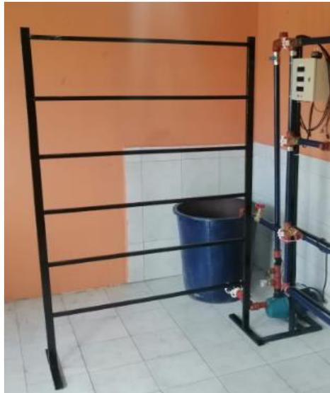
*Figura 3.2 Estructura del módulo, posicionamiento de la bomba, tanque y tablero*
