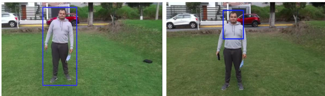
Figura 2.7 Ejemplo de Haar Cascade para detectar un cuerpo entero. Al lado izquierdo se tiene una identificación correcta, mientras que en el derecho se presenta un error típico de bounding box en estos algoritmos
