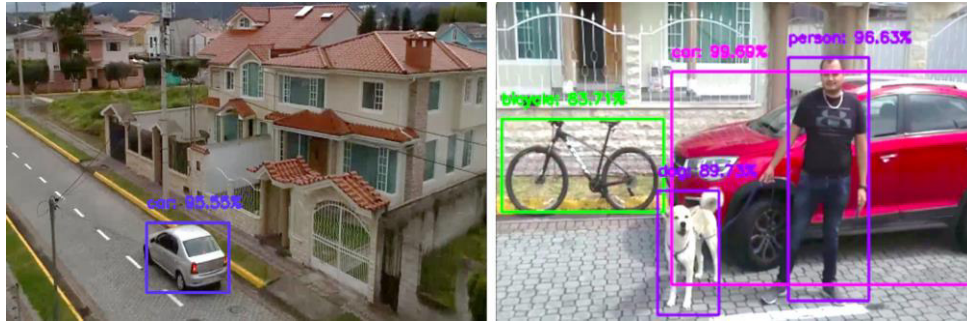
Figura 2.10 Identificación de varias clases (carro, bicicleta, persona, perro) con la red SSD MobileNet V2
