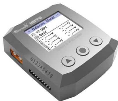
Figura 2.23. Analizador de potencia M8PRO [80].
