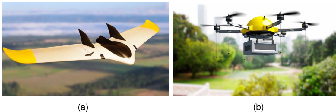
Figura 1.2. Tipos de UAVs (a) Ala fija (b) Ala rotatoria [18].
