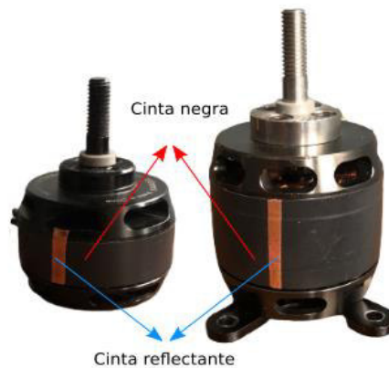
Figura 2.17. Modificación del rotor de cada motor [Fuente propia].
