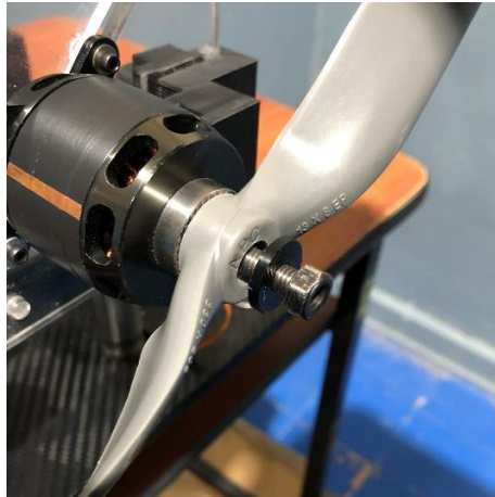
Figura H.3. Ajuste de la hélice al eje del motor.
