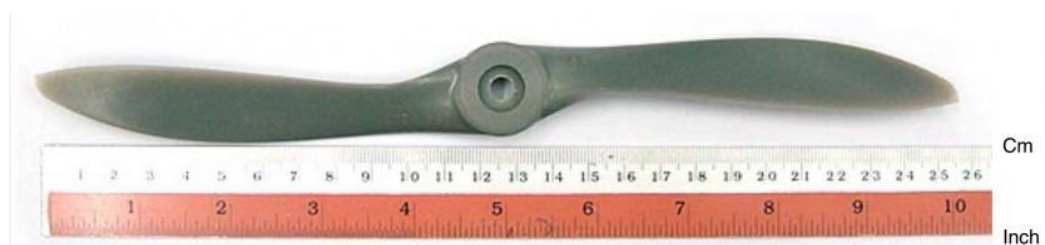
Figura 1.7. Representación del diámetro de una propela [27].
