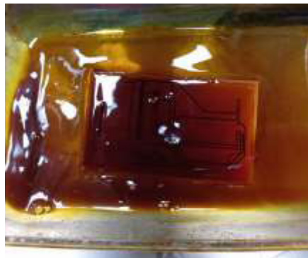
Figura 3.33 Placa sumergida en ácido férrico
