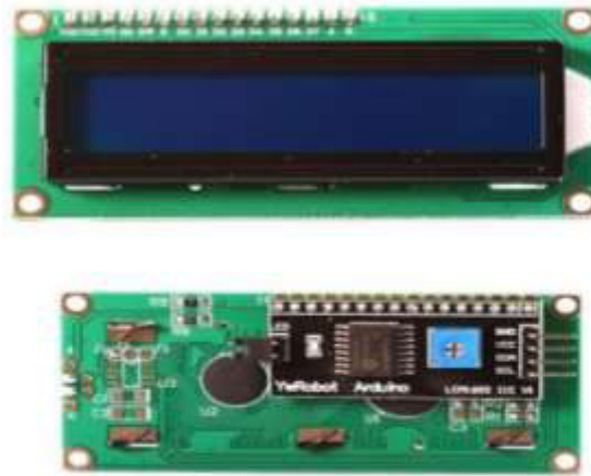
Figura 1.8. Pantalla LCD I2C [9]
