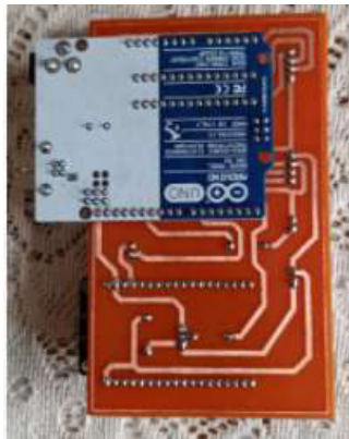
Figura 3.36 Ubicación de Arduino en placa PCB
