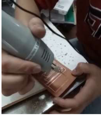
Figura 3.35 Perforación de la placa
