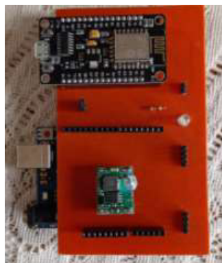
Figura 3.37 Ubicación del módulo WiFi en la placa PCB
