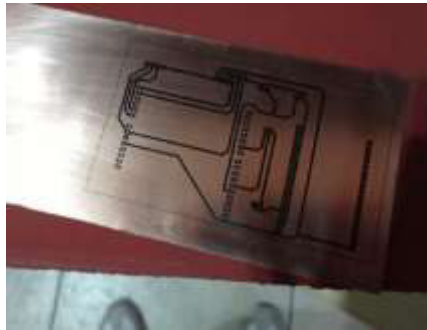
Figura 3.32 Placa retirada de la plancha
