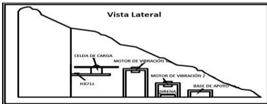
Figura 3.13 Vista lateral para sensor de peso, motores de vibración y bases
