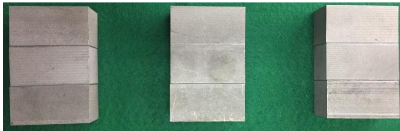
Figura 2. 3 Probetas extraídas mediante corte por electroerosión. (Fuente: Propia)
