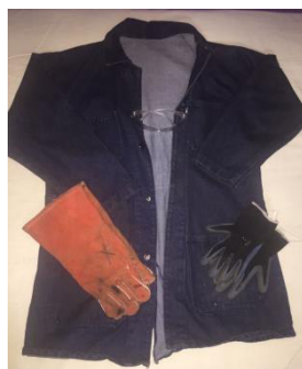
Figura 2. 10 Equipo de protección personal para extraer la caja del horno. (Fuente: Propia)
