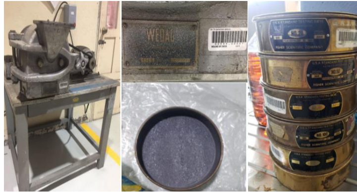
Figura 2. 5 Proceso de trituración en molino de discos. (Fuente. Propia)
