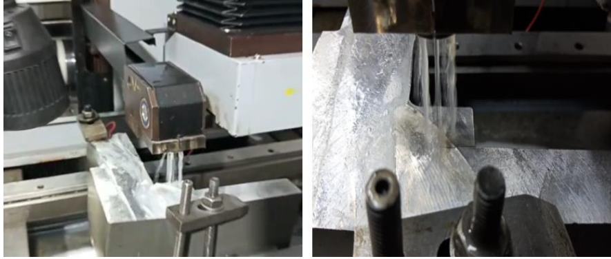
Figura 2. 2 Proceso de corte por electroerosión de hilo. (Fuente: Propia)
