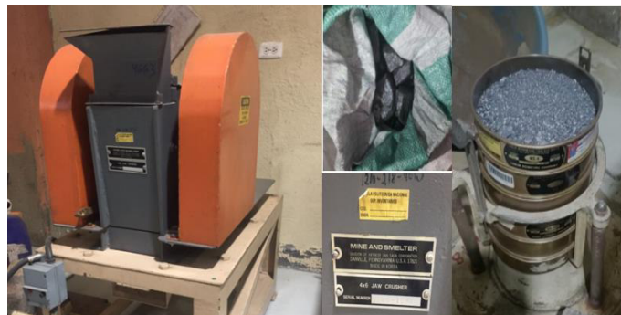
Figura 2. 4 Proceso de trituración en molino de mandíbulas. (Fuente: Propia)
