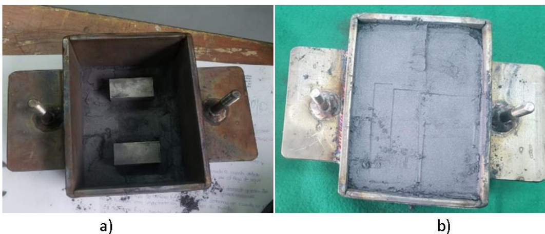
Figura 2. 12 Disposición de las probetas en la caja. b) Caja llena de material particulado.
