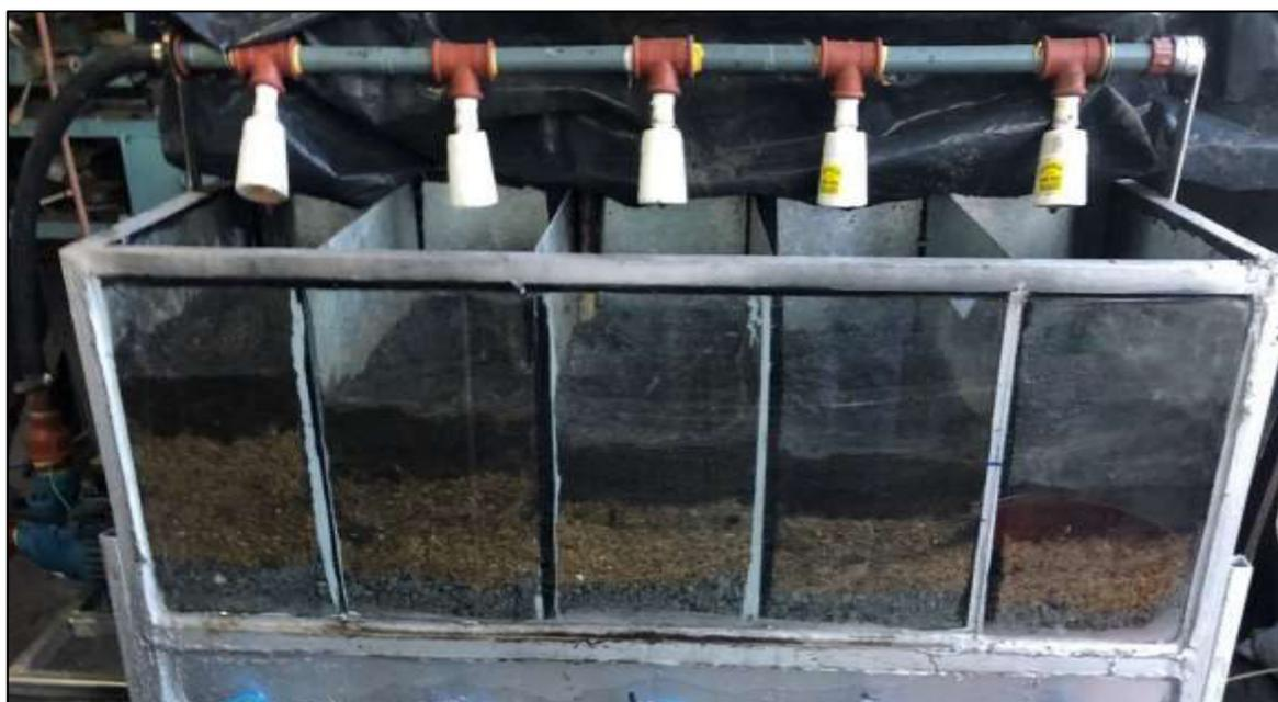
**Figura FTX.6** Instalación del sistema de irrigación
