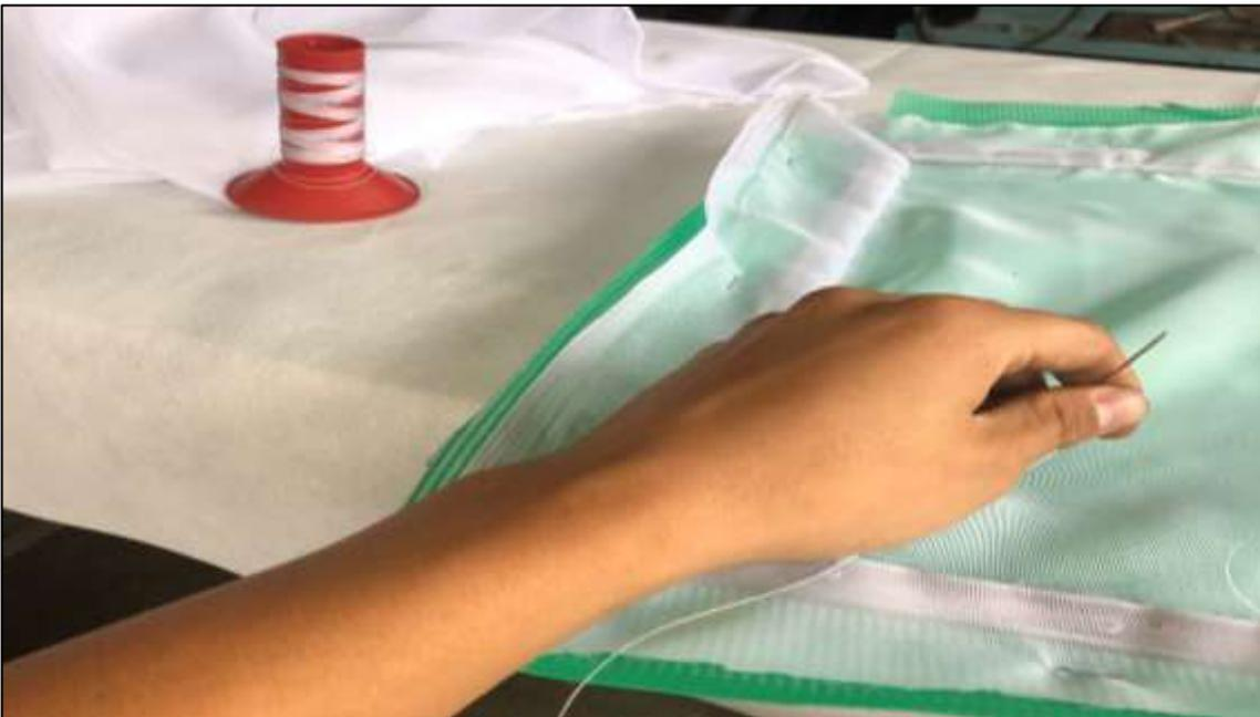
**Figura FTX.2** Costura de malla Nro. 10 con la malla textil (organza).
