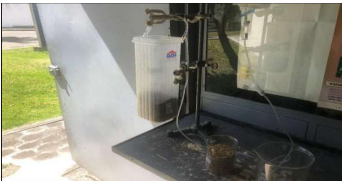
**Figura FTVI.1** Ensayo de filtración por goteo
