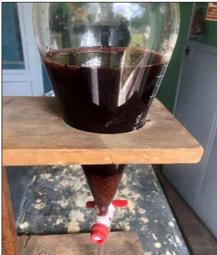
**Figura FTVII.1** Ensayo de tiempo de separación de aceites y grasas en embudos de separación.
