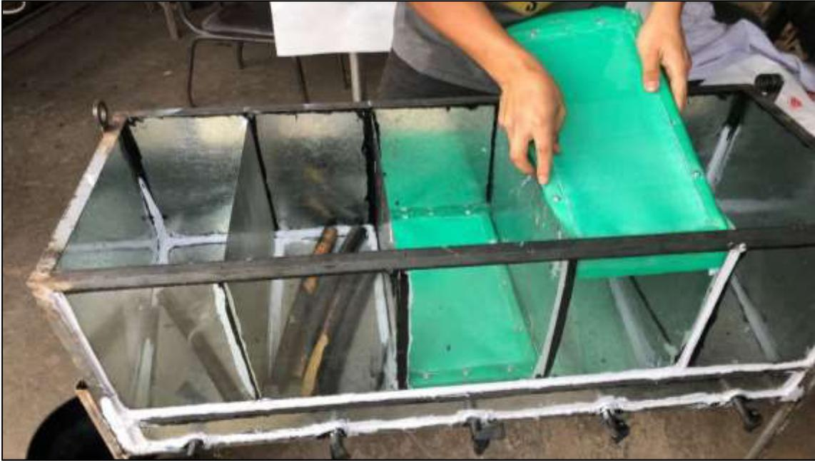
**Figura FTX.3** Instalación de cuadro metálico con malla Nro. 10. y malla textil (organza)
