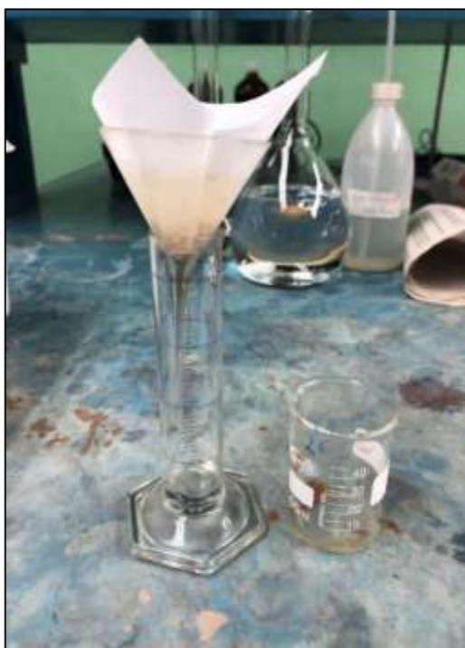
**Figura FTXIV.7** Filtración de hidróxidos de hierro del efluente tratado.
