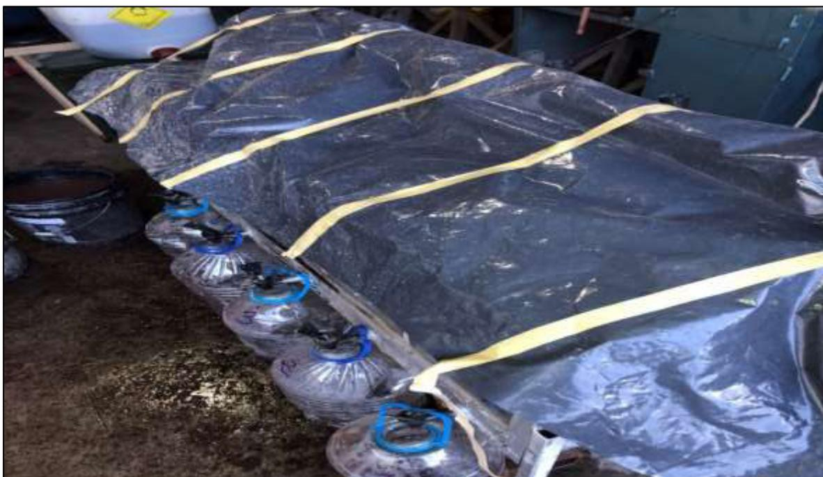
**Figura FTX.8** Sistema de biofiltración cubierto con plástico negro.
