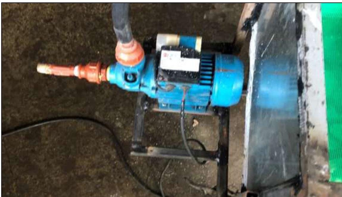
**Figura FTX.5** Bomba de ½ HP
