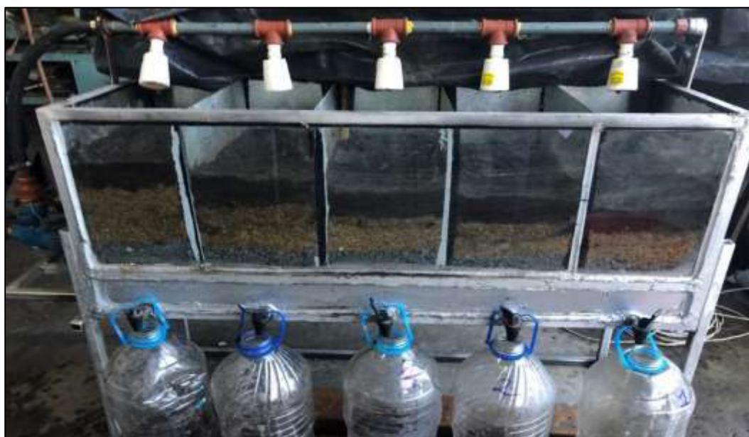
**Figura FTXI.1** Biofiltros en función de la altura de biofiltración obtenida (Vista de mayor a menor)
