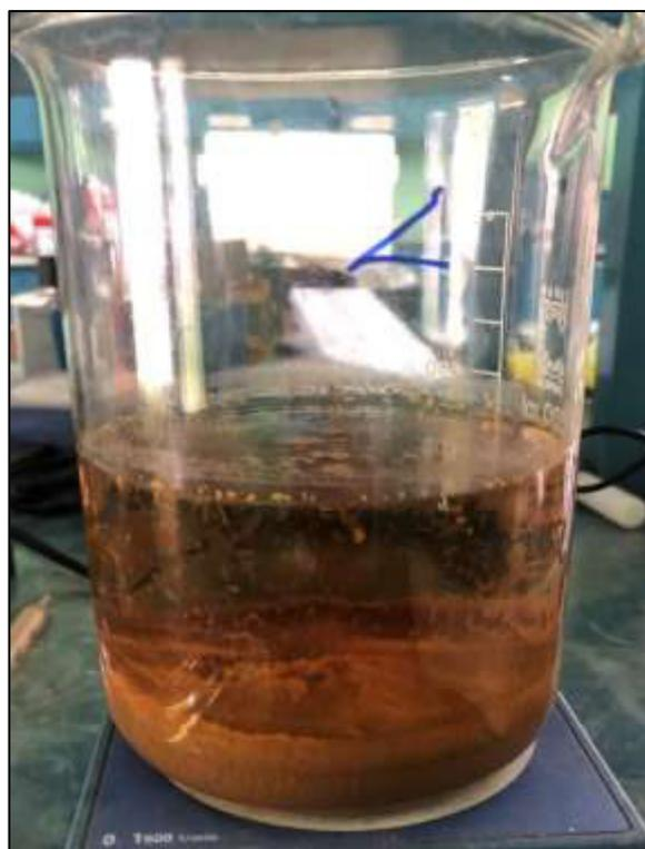
**Figura FTXIV.8** Resultado del proceso Fenton convencional en un tiempo de reacción de 120 min con la dosis de 12,8 mM  $\text{Fe}^{2+}$  y 32 mM de  $\text{H}_2\text{O}_2$
