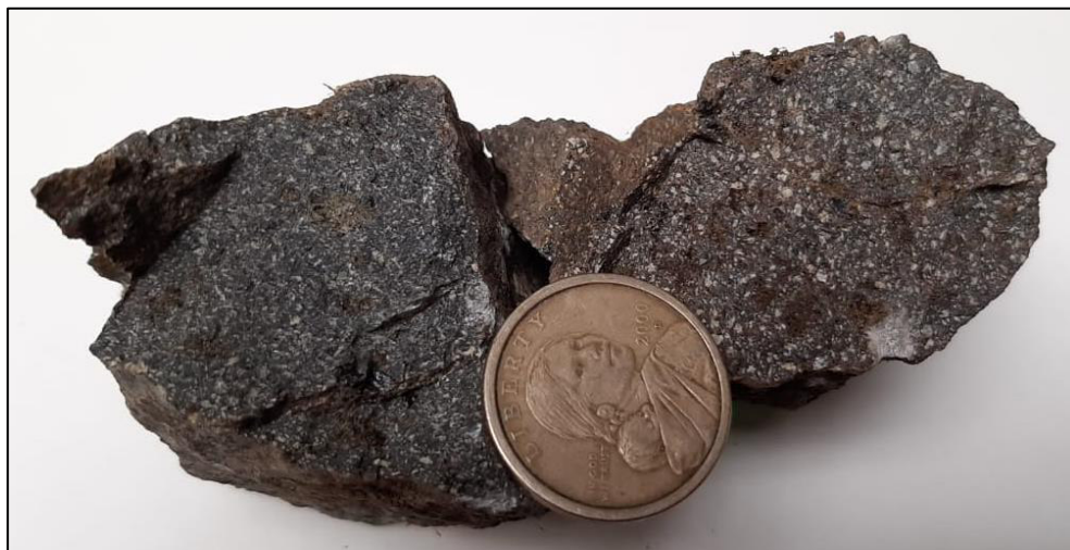
Fotografía 14 Andesita basáltica con presencia de piroxenos (Foto: K. Arequipa - EPN).
