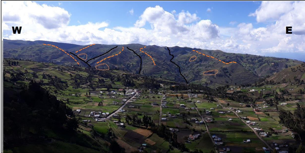
Fotografía 30 Líneas negras continuas indican zonas de fallas con tendencia NS, líneas discontinuas de color tomate indican lineamientos NS, figuras de color café indican antiguas zonas de deslizamientos posiblemente asociadas al movimiento de fallas aledañas (Foto: K. Arequipa - EPN)
