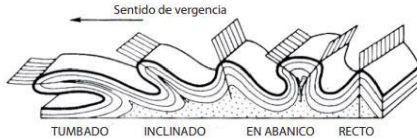
Figura 13 Clasificación de pliegue según la inclinación del plano axial
