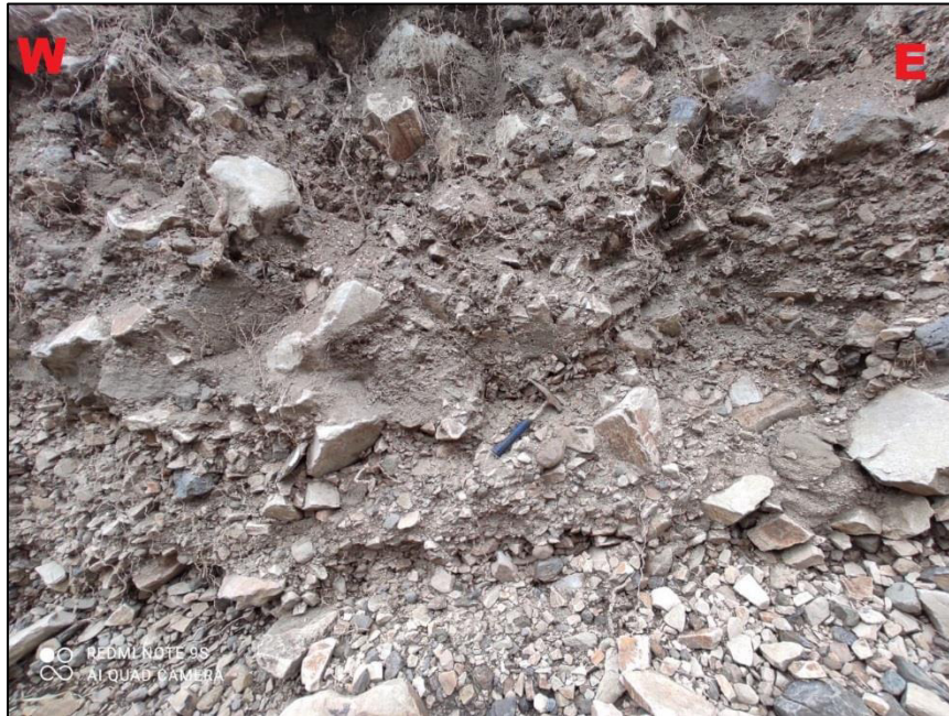
Fotografía 29 Fragmentos de rocas subangulosas y subredondeados de tamaño métrico a centimétrico de composición volcánica UTM 751006 – 9893553 (Foto: K. Arequipa - EPN).
