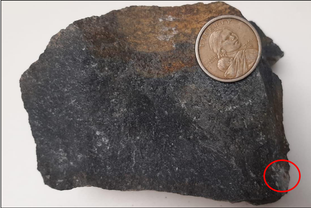
Fotografía 12 Andesítica con presencia de sílice granular indicada en el círculo de color rojo (Foto: K. Arequipa - EPN).
