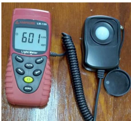
**Figura 3.12** Medición del sistema de iluminación con un luxómetro
