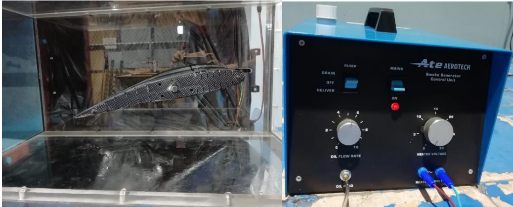
Figura 2.5. Montaje de la cámara, cámara de humo y equipo de toma de resultados. (Fuente: Propia)
