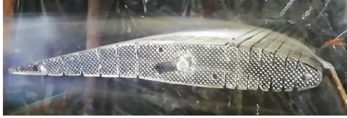
Figura 3.2. Comportamiento de fluido en el túnel de viento desde el perfil base 0012 al 4412. (Fuente: propia)
