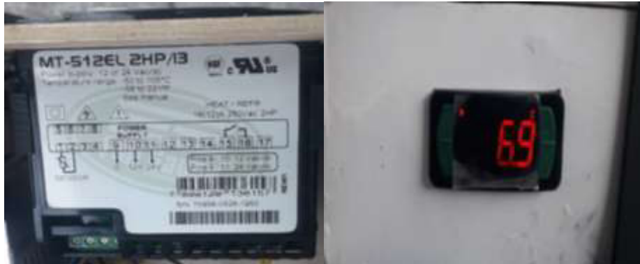
Figura 3.9 Controlador de temperatura Full Gauge.
