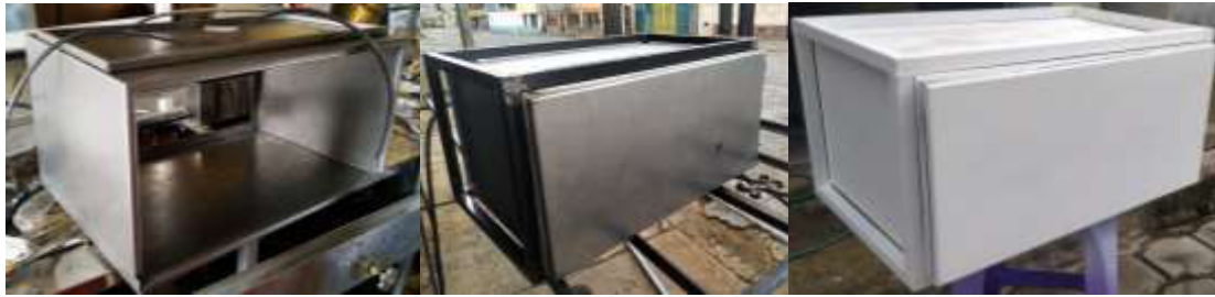
Figura 3.13 Construcción de la cámara de enfriamiento
