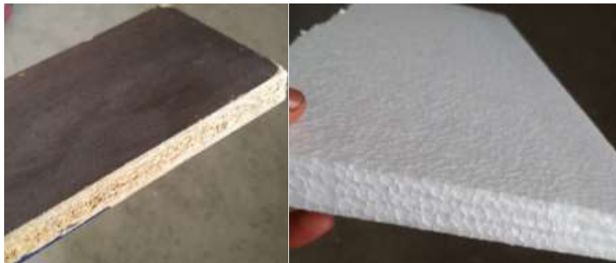
Figura 3.15 Materiales aislantes para las paredes (madera y poliestireno).
