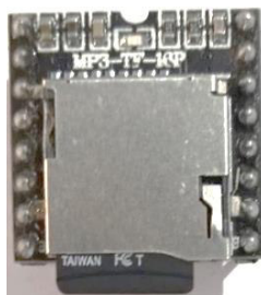
Figura 3.9 Módulo reproductor de audio DFPLAYER MINI [19].
