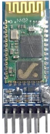
Figura 3.7 Módulo bluetooth HC-05 [17].
