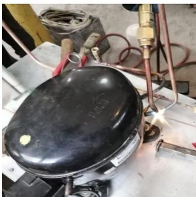
**Figura 3.28** Soldadura descarga del compresor.
