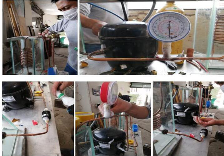
**Figura 3.35** Verificación de fugas en uniones soldadas y roscadas.
