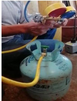
**Figura 3.37** Cilindro de gas refrigerante.
