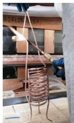
**Figura 3.30** Soldadura de trípode y acople para evaporador.
