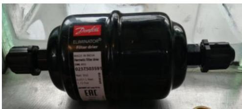
**Figura 3.14** Filtro deshidratador Danfoss 2.0 TR DML-032.
