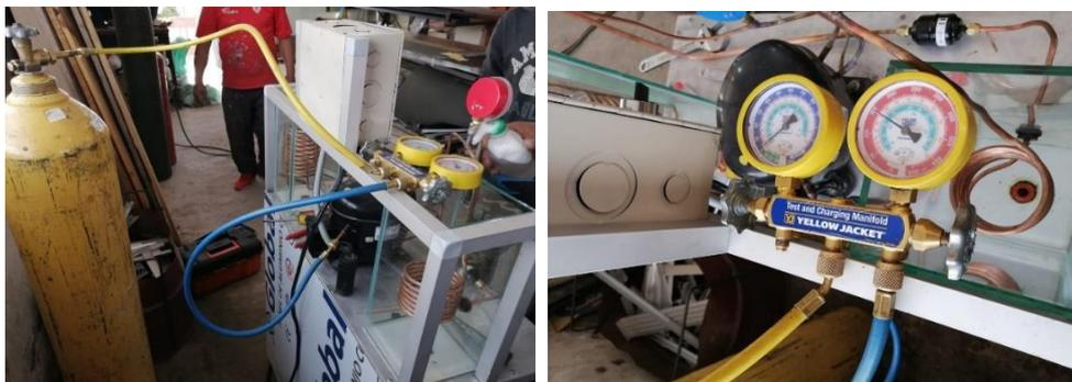
**Figura 3.34** Presurización con nitrógeno al módulo.
