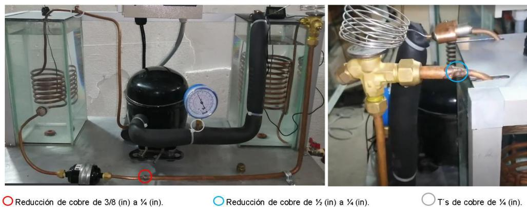
**Figura 3.10** Reducciones y T's de cobre utilizadas.
