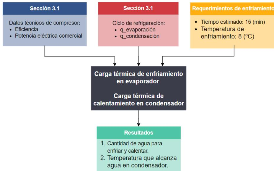
**Figura 3.6** Metodología para cálculo de carga térmica.
