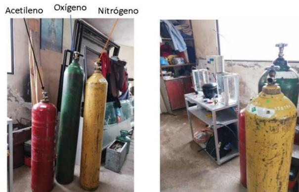
**Figura 3.27.** Tanque de acetileno, oxígeno y nitrógeno.
