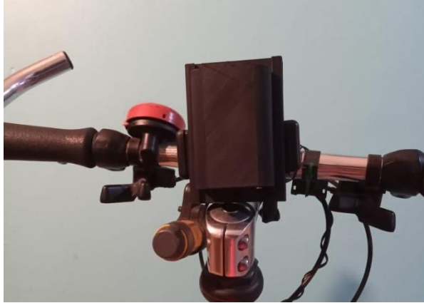
Figura 3.17 Caja del módulo maestro en el manubrio
