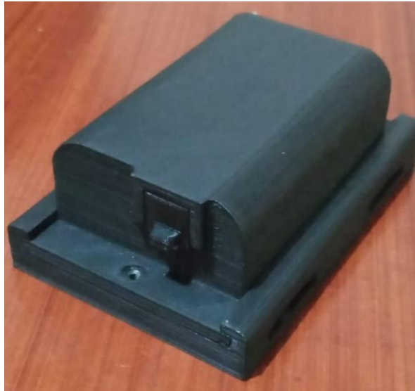
Figura 3.15 Caja del módulo maestro
