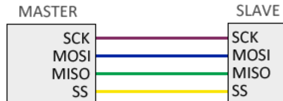
Figura 3.1 Conexión del SPI [15]
