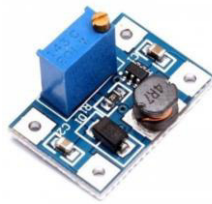
Figura 2.7. Módulo elevador de voltaje.
