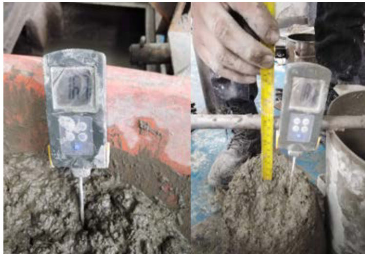
Fotografía 70: Toma de temperatura al hormigón fresco Elaborado por: Chiquito, J & Eras, G
