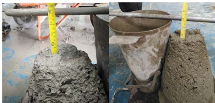
Fotografía 68: Asentamiento del hormigón simple con fibras Elaborado por: Chiquito, J & Eras, G
