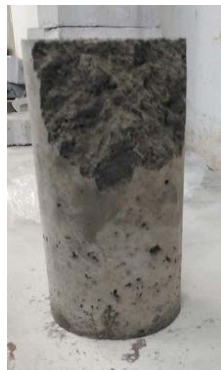
Fotografía 59: Tipo de falla del cilindro patrón (Falla 5)
