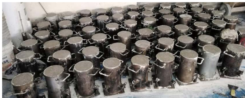
Fotografía 72: Elaboración de las probetas cilíndricas de hormigón con fibra Elaborado por: Chiquito, J & Eras, G
