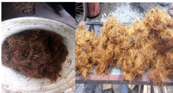
Fotografía 39: Aplicación del NaOH a la fibra. Elaborado por: Chiquito, J & Eras, G
