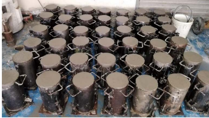
Fotografía 71: Elaboración de las probetas cilíndricas de hormigón sin fibra Elaborado por: Chiquito, J & Eras, G
