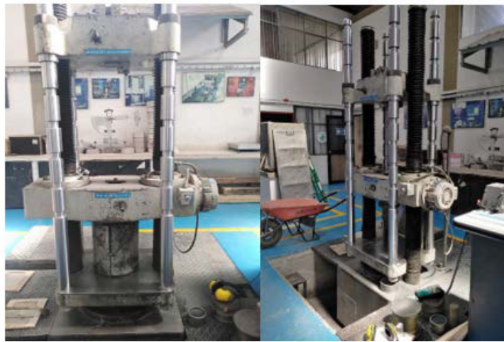
Fotografía 13: Maquina universal de Cargas Elaborado por: Chiquito, J & Eras, G
