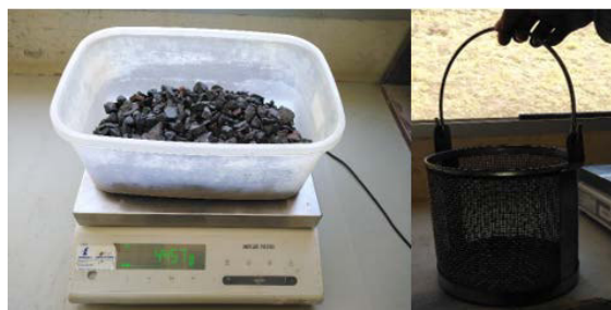
Fotografía 23: masa del agregado en estado saturado.
