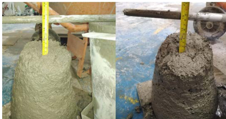
Fotografía 62: Prueba de asentamiento del hormigón 210kgf/cm 2 al 0.5% y 1.0% de fibras Fuente: Chiquito, J & Eras, G
