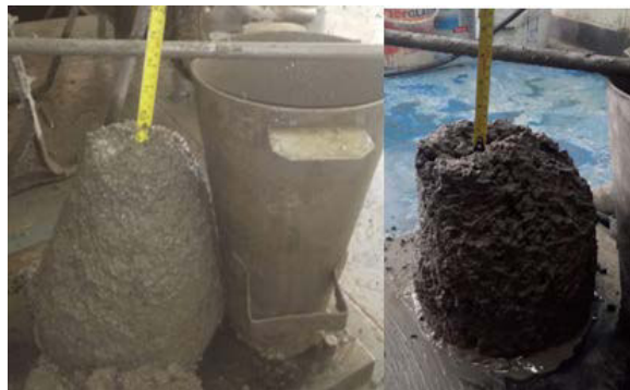
Fotografía 67: Asentamiento del hormigón simple Elaborado por: Chiquito, J & Eras, G
