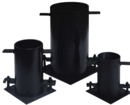
Figura 16: Moldes de acero.
