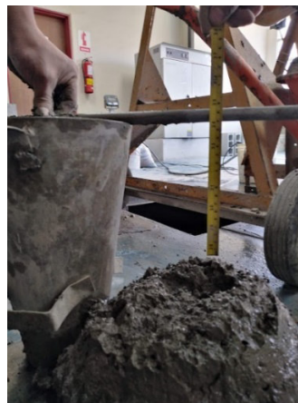
Fotografía 56: Prueba de asentamiento del hormigón
