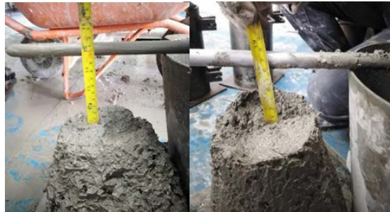
Fotografía 63: Prueba de asentamiento del hormigón 240kgf/cm 2 al 0.5% y 1% de fibras Fuente: Chiquito, J & Eras, G.
