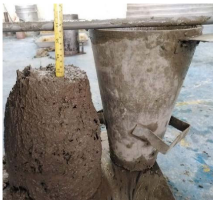
Fotografía 60: Prueba de asentamiento del hormigón
