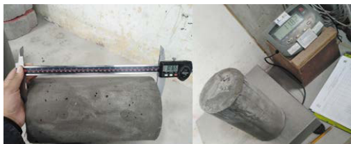
Fotografía 75: Toma de dimensiones de las probetas cilíndricas Elaborado por: Chiquito, J & Eras, G
