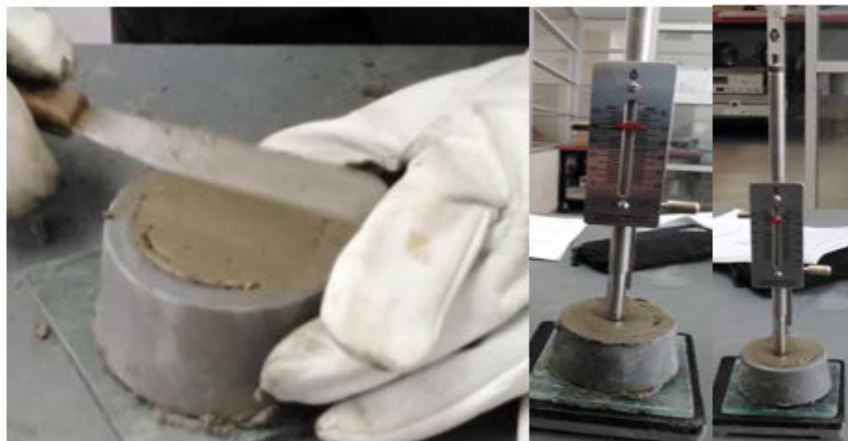
Fotografía 19: Ensayo de consistencia normal del cemento Elaborado por: Chiquito, J & Eras, G
