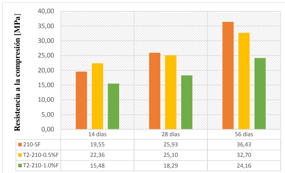
Figura 72: Comparación de f'_c 21MPa, respecto a la inmersión de 0.5 y 1.0% de fibra con tratamiento 2. Elaborado por: Chiquito, J & Eras, G
