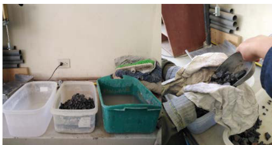
Fotografía 22: Secado de la superficie del agregado grueso.
