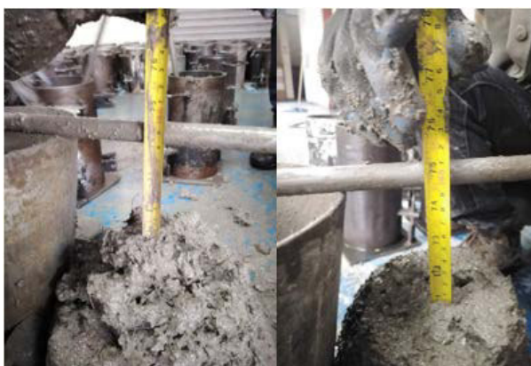
Fotografía 64: Prueba de asentamiento del hormigón 210kgf/cm 2 al 0.5% y 1% de fibras
