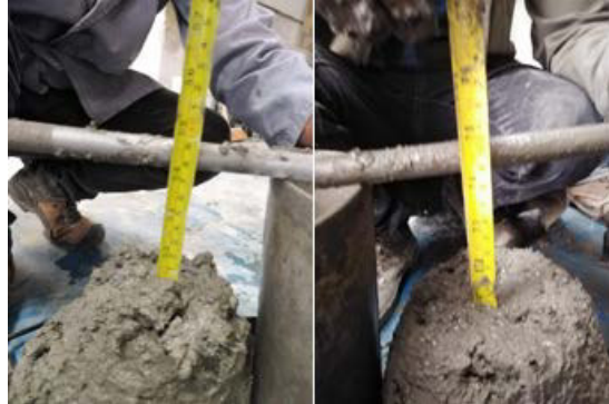
Fotografía 65: Prueba de asentamiento del hormigón 240kgf/cm 2 al 0.5% y 1.0% de fibras Elaborado por: Chiquito, J & Eras, G
