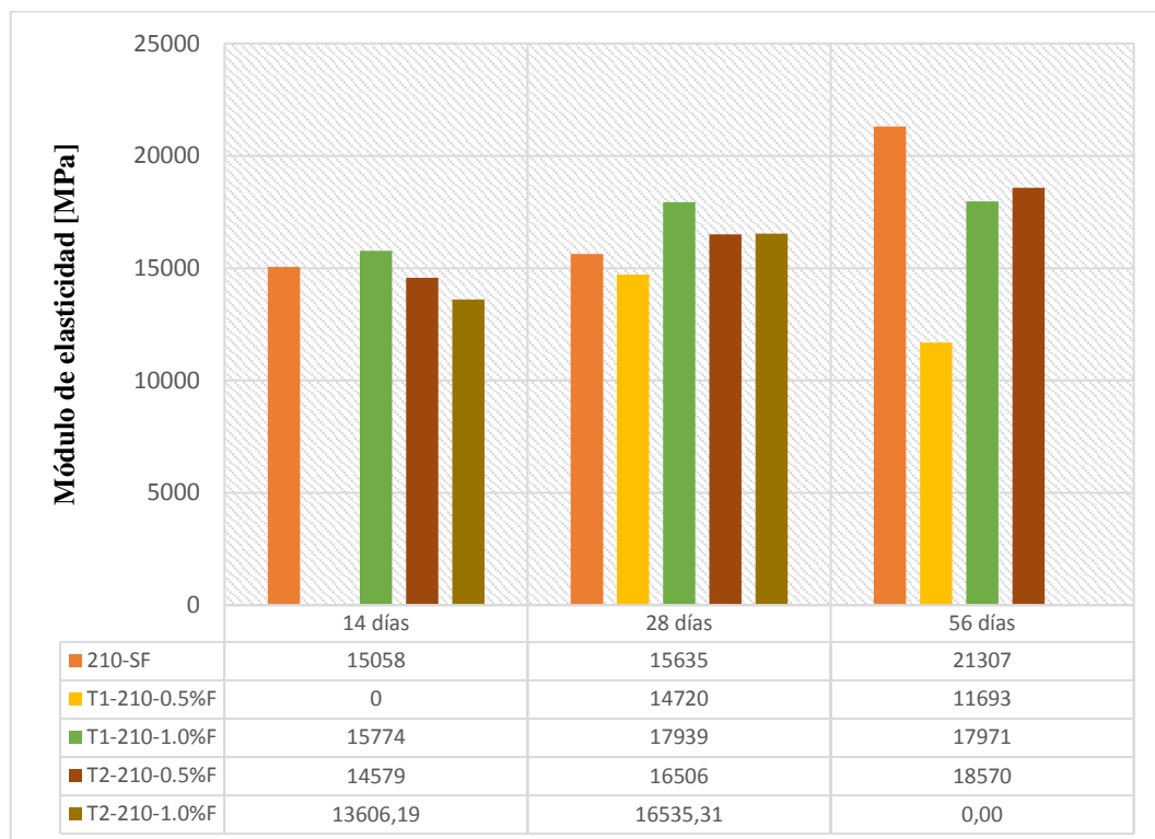
Figura 78: Resumen valores de módulos de elasticidad respecto a f'c 210 kgf/cm 2 .
