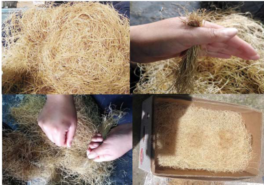
Fotografía 27: Desfibramiento y almacenamiento de la fibra.
