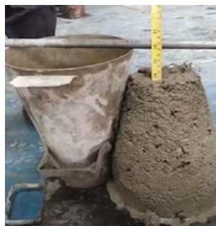
Fotografía 58: Prueba de asentamiento del hormigón
