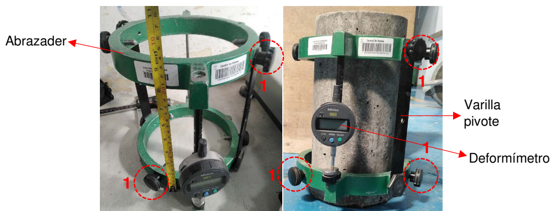
Fotografía 12: Puntos de calibre (Puntos de sujeción), se incrustan en el espécimen.
