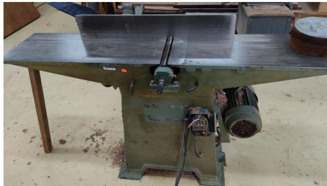
Figura 3.1. Máquina canteadora Dafigo de la carpintería
