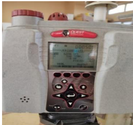
Figura 2.2. Equipo de medición puntual de concentración de material particulado 3M serie EVM
