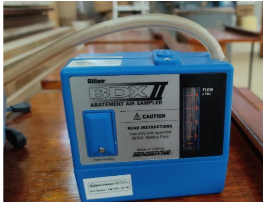
Figura 2.3. Bomba de aspiración Gilian BDXII y manguera de conexión
