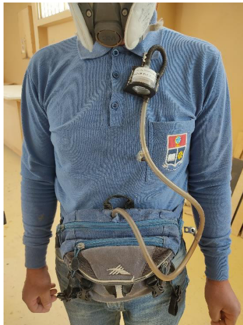
Figura 3.4. Trabajador con equipo de medición de material particulado sujeto a su ropa
