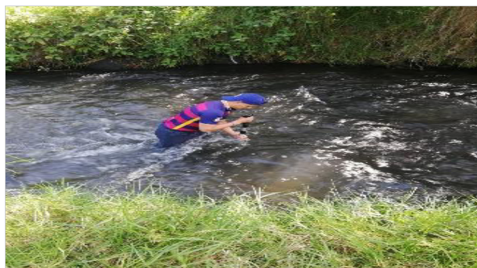
Figura 10. Medición del caudal con el caudalímetro.
